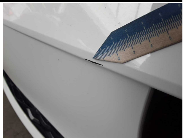
Beschädigung #5: Stossfänger vorn: Stossfänger vorn - Kratzer - lackieren
