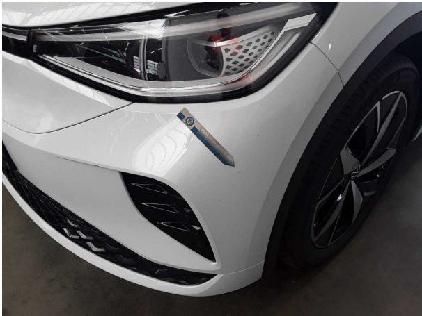
Beschädigung #5: Stossfänger vorn: Stossfänger vorn - Kratzer - lackieren
