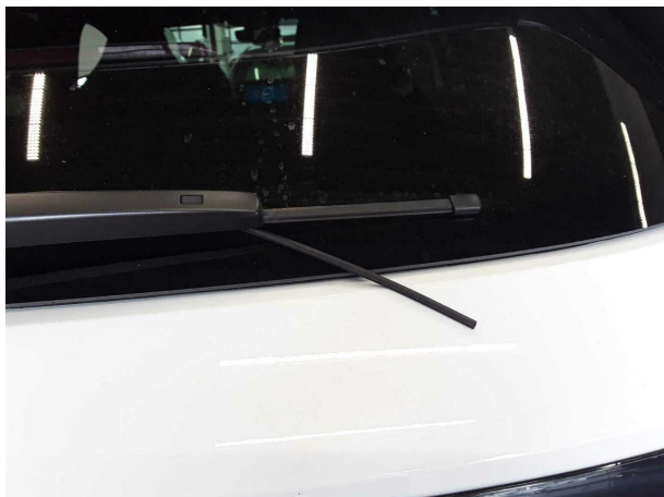
Beschädigung #1: Scheibenreinigung: Scheibenwischerblatt hinten - gebrochen / gerissen - erneuern
