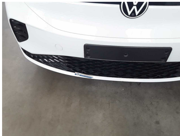
Beschädigung #2: Stossfänger vorn: Spoiler - Kratzer - lackieren
