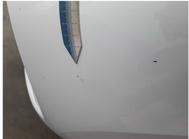
Beschädigung #5: Stossfänger vorn: Stossfänger vorn - Kratzer - lackieren
