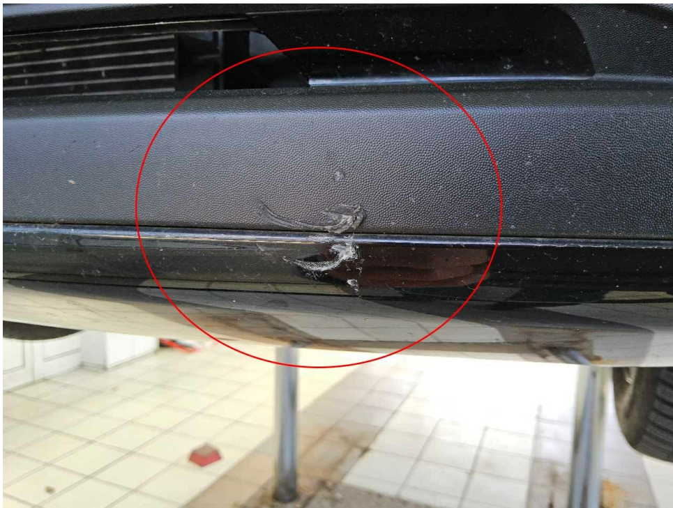
Bild 14 : Frontspoiler, verformt, erneuern
