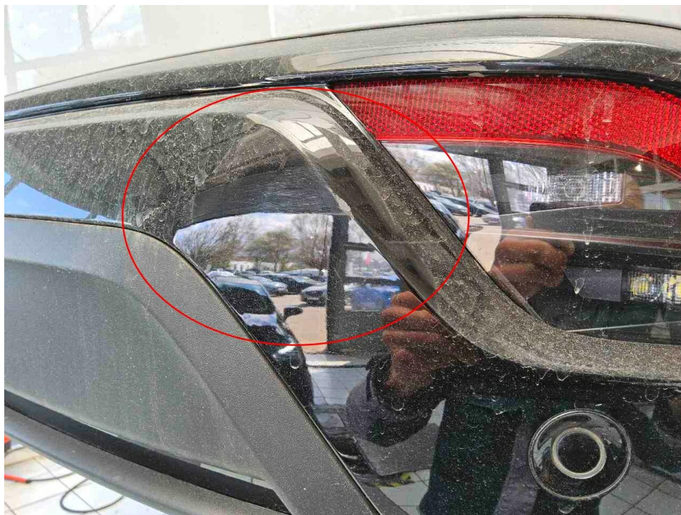
Bild 18 : Stoßfänger hinten Lackierung, verschrammt, smart repair
