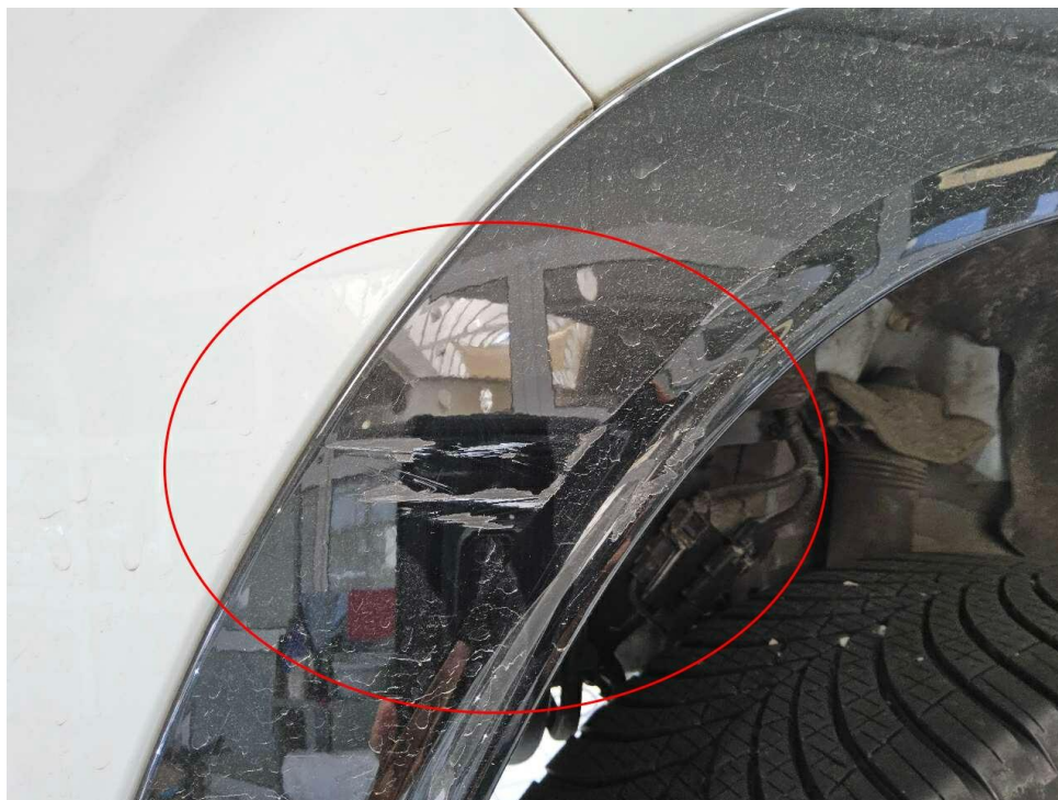
Bild 17 : Seitenteil hinten rechts Schutzleiste Lackierung, zerkratzt, smart repair
