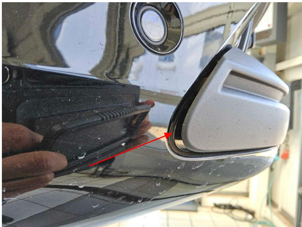
Bild 16 : Frontspoiler, verformt, erneuern
