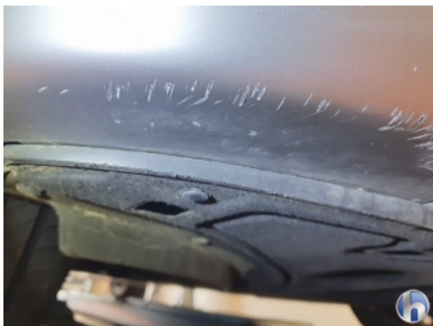
1. Frontspoiler Gebrauchsspuren - Ohne Reparatur
