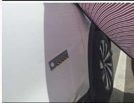
Porta / Anteriore Destro / Ammaccato vernice incisa
