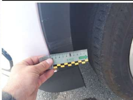
Modanatura parafrangente / Anteriore Sinistro / Scheggia
