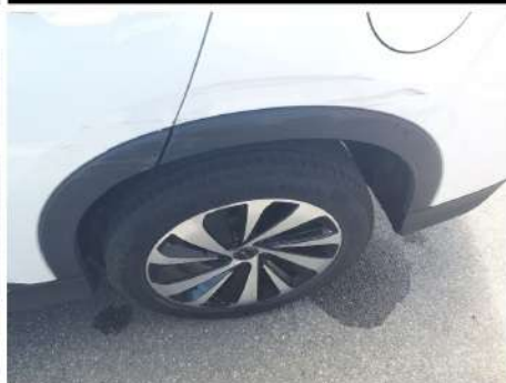
Modanatura parafrangente / Posteriore Sinistro / Scheggia
