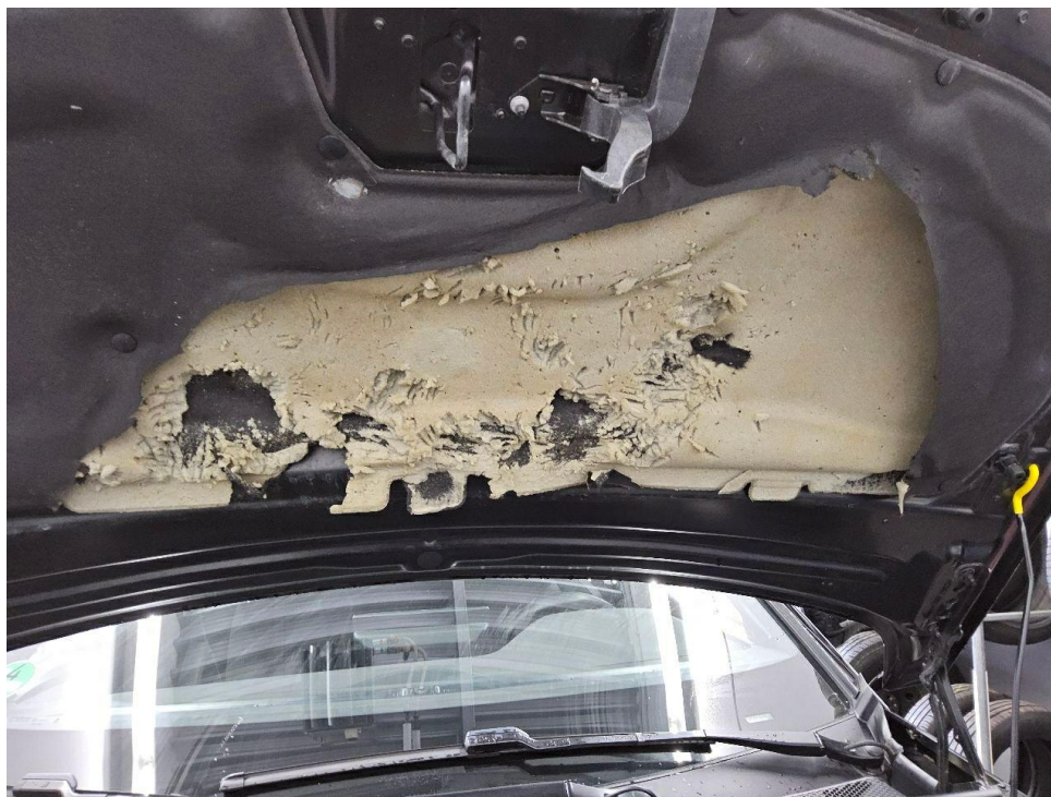
Bild 12 : Motordämmmatte und Dämmung Stirnwand gerissen
