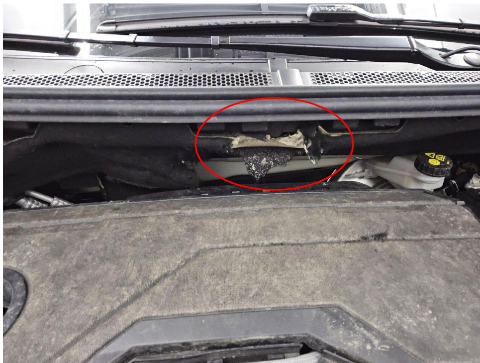
Bild 13 : Motordämmmatte und Dämmung Stirnwand gerissen
