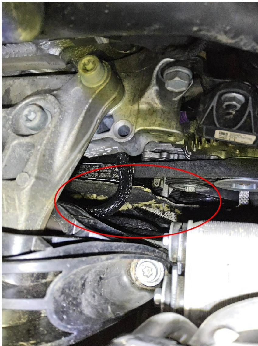
Bild 16 : Motordämmmatte und Dämmung Stirnwand gerissen
