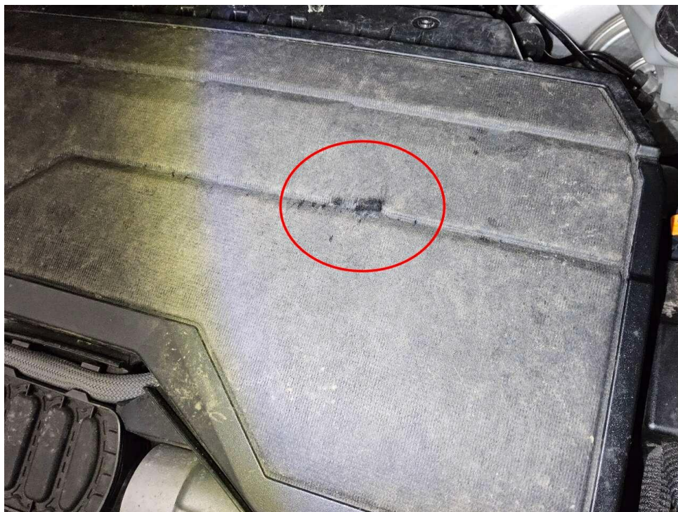
Bild 17 : Motordämmmatte, Dämmung Stirnwand, Keilriemenabdeckung, Motorabdeckung, gerissen
