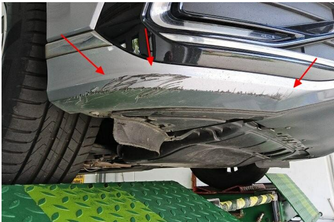
Bild 16 : Frontspoiler, verschrammt, lackieren mit Lackaufbau
