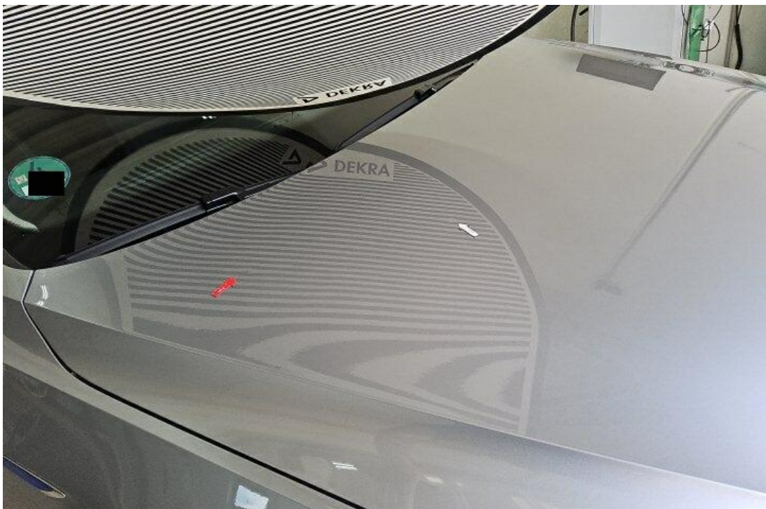
Bild 18 : Motorhaube, eingedellt, Gebrauchsspur
