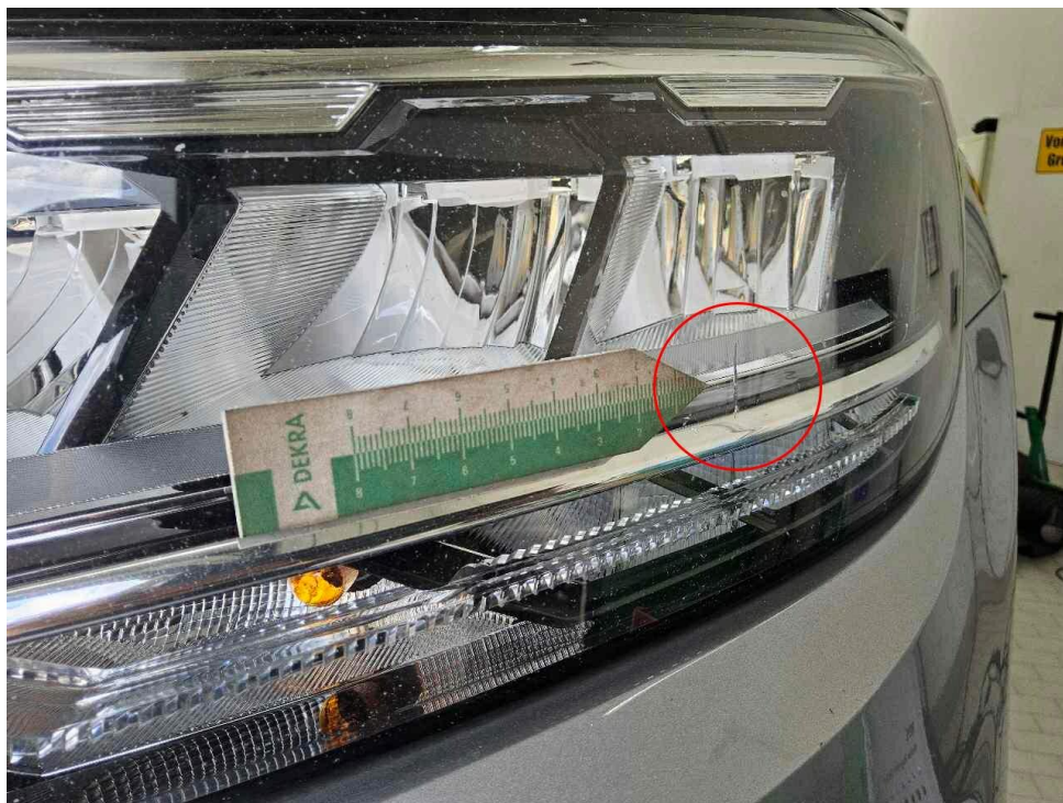
Bild 22 : Scheinwerfer links - Sprung
