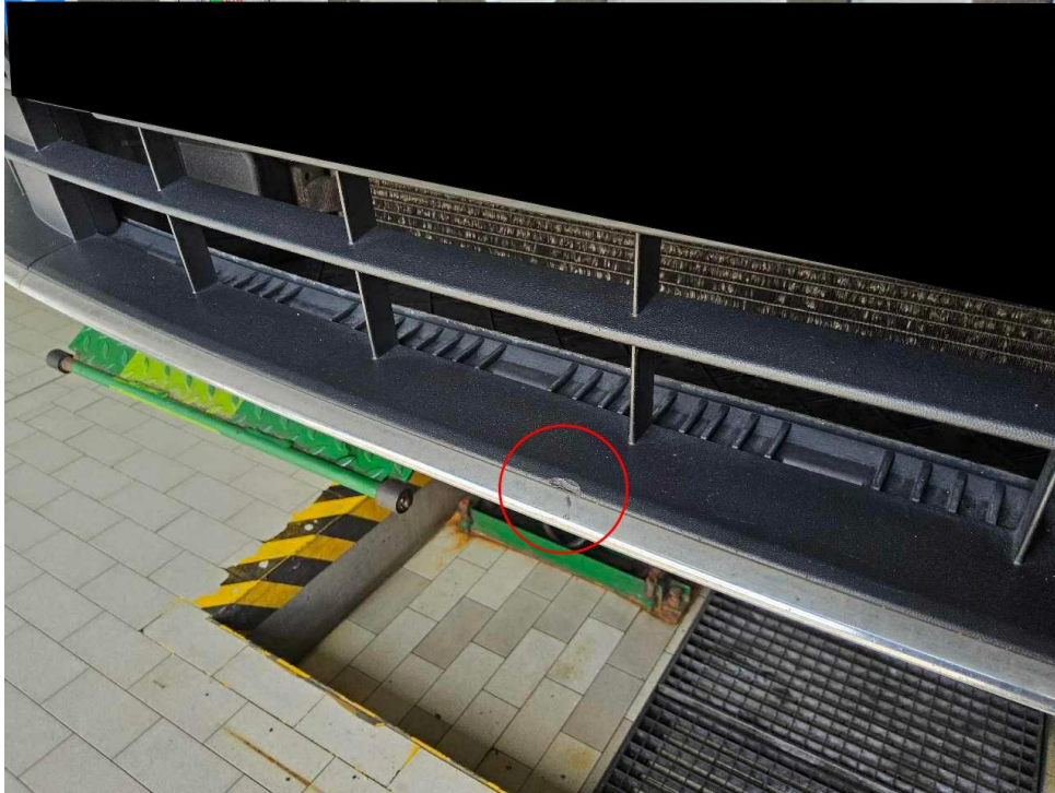
Bild 23 : Stoßfänger vorne - Grill mitte gebrochen
