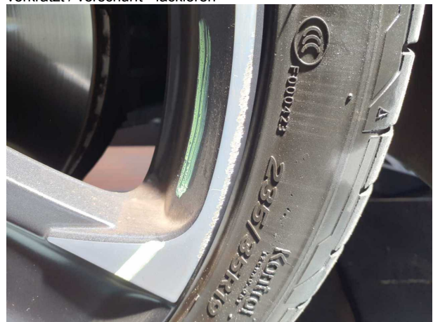
Beschädigung #5: Rad/Reifen: Leichtmetallfelge vorn links - verkratzt / verschürft - erneuern
