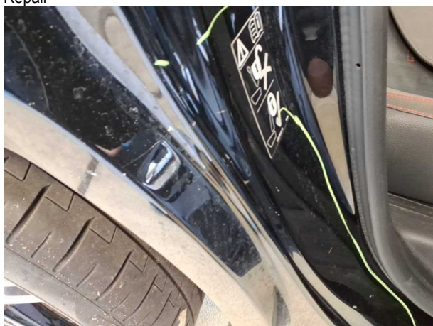
Beschädigung #9: Seitenwand rechts: Einstieg - Delle(n) - Smart Repair
