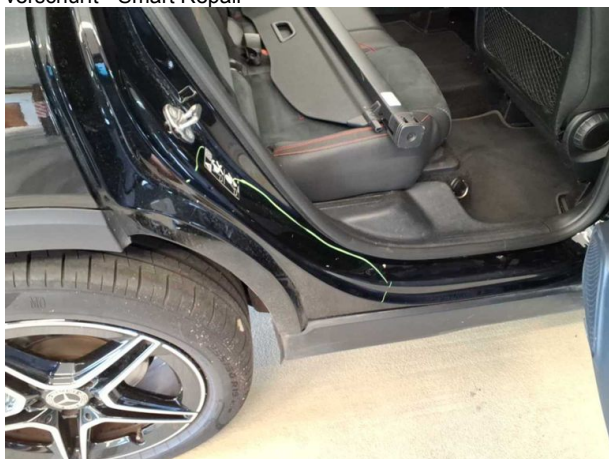
Beschädigung #9: Seitenwand rechts: Einstieg - Delle(n) - Smart Repair
