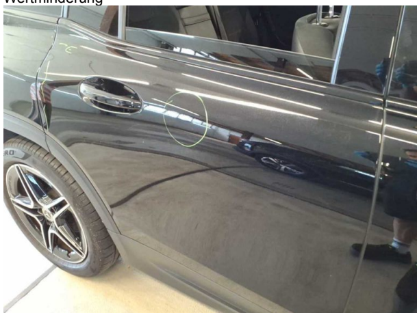
Beschädigung #4: Tür hinten rechts: Tür - Delle(n) - sanft instandsetzen
