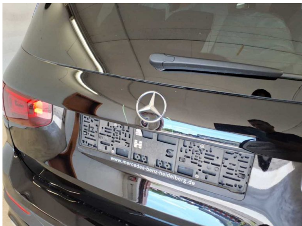
Beschädigung #2: Heckklappe/-tür: Heckklappe - Delle(n) - sanft instandsetzen
