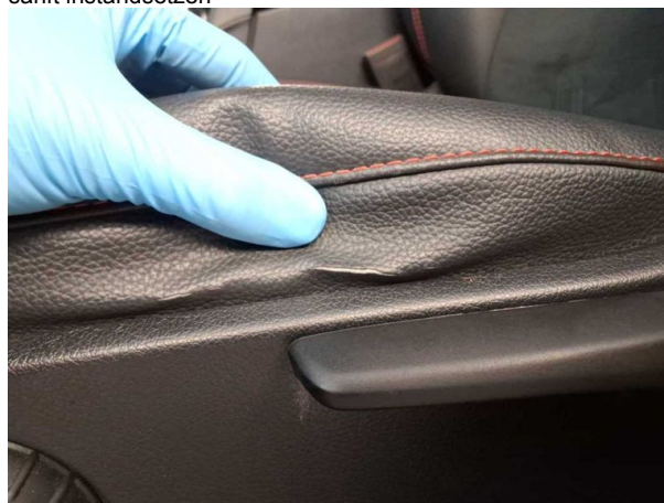
Beschädigung #3: Sitz vorn: Sitzbezug links - beschädigt - Wertminderung
