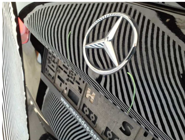
Beschädigung #2: Heckklappe/-tür: Heckklappe - Delle(n) - sanft instandsetzen
