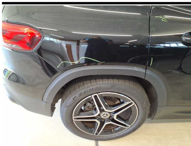
Beschädigung #5: Seitenwand rechts: Radhausverbreiterung - Fehlstellung - de-/montieren
