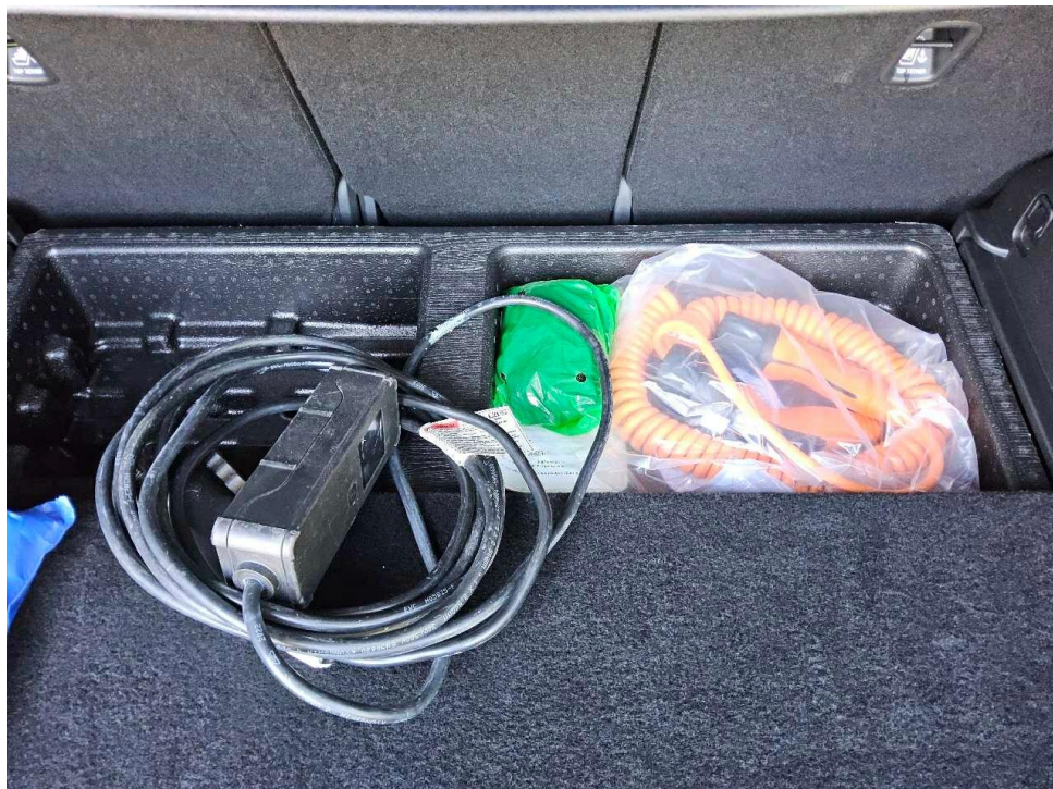
Bild 6 : Ladekabel beim E-Fahrzeug
