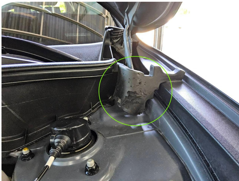
Bild 8 : Tierversbiss Motorraum, Schaumstoffecken erneuern
