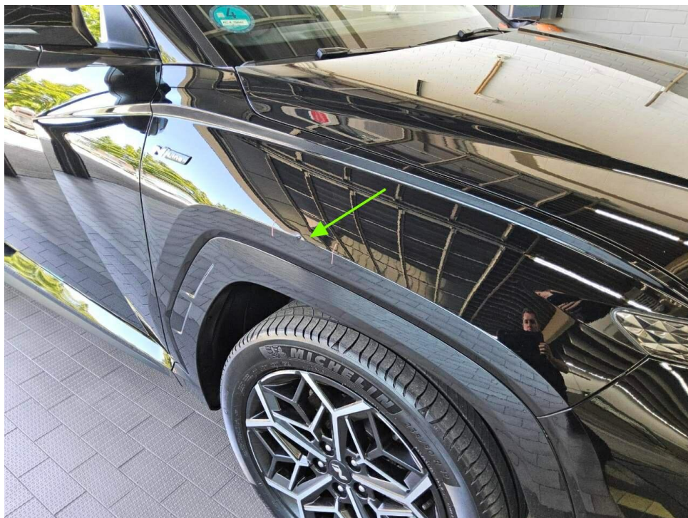
Bild 12 : Kotflügel vorne rechts, verformt, instandsetzen und lackieren mit Lackaufbau
