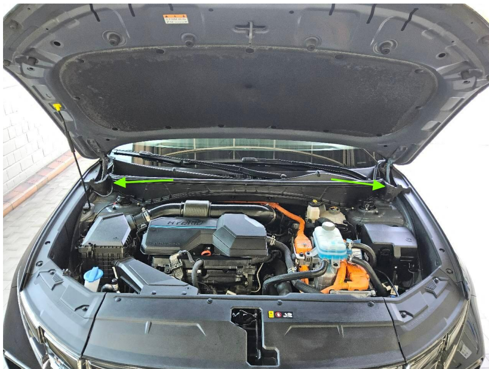
Bild 7 : Tierversbiss Motorraum, Schaumstoffecken erneuern
