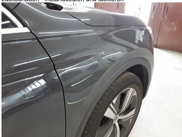
Beschädigung #7: Kotflügel rechts: Kotflügel rechts - verkratzt / verschürft - instandsetzen und lackieren
