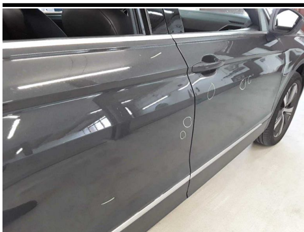
Beschädigung #8: Tür hinten rechts: Tür - Delle / Lackschaden - instandsetzen und lackieren
