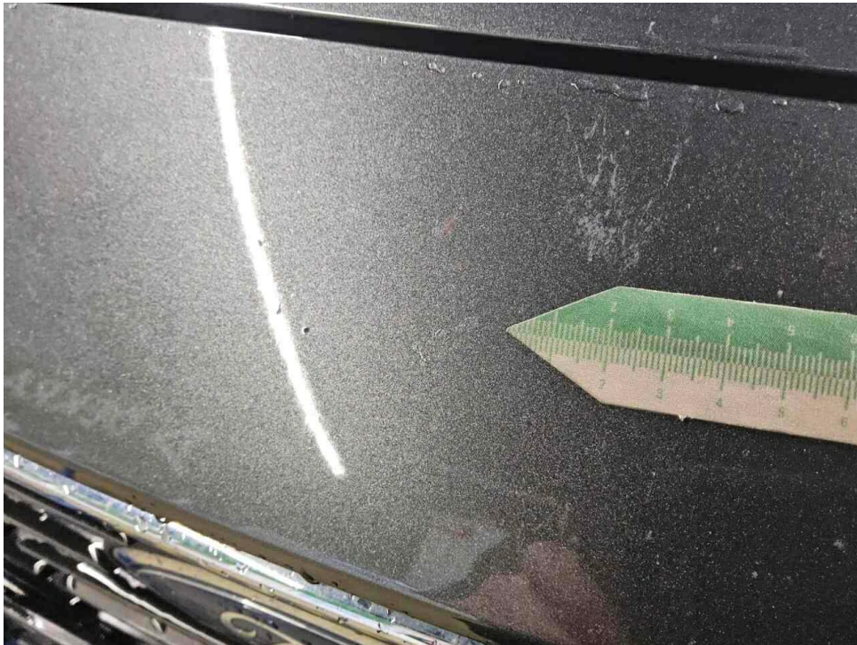
Bild 19 : Stoßfänger vorne Lackierung, Steinschlag, Gebrauchsspur
