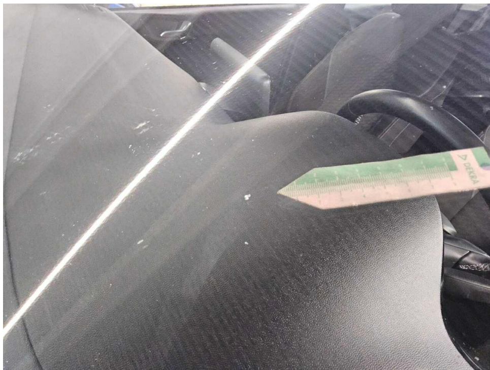
Bild 17 : Frontscheibe, Steinschlag, Gebrauchsspur
