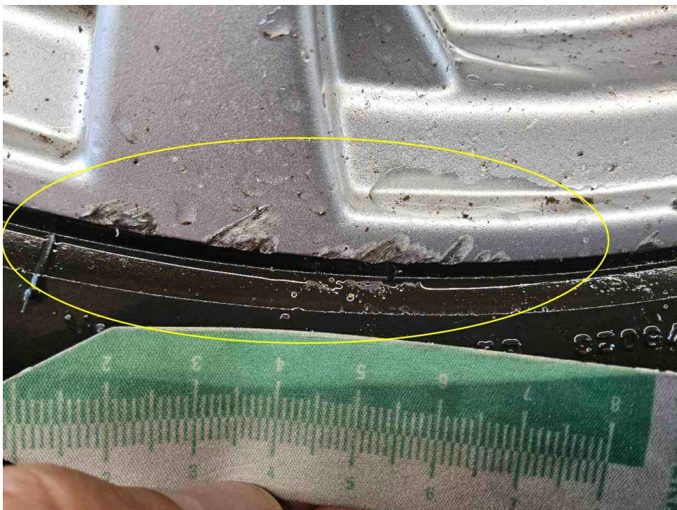
Bild 20 : LM Felge hinten rechts verschrammt, Winter
