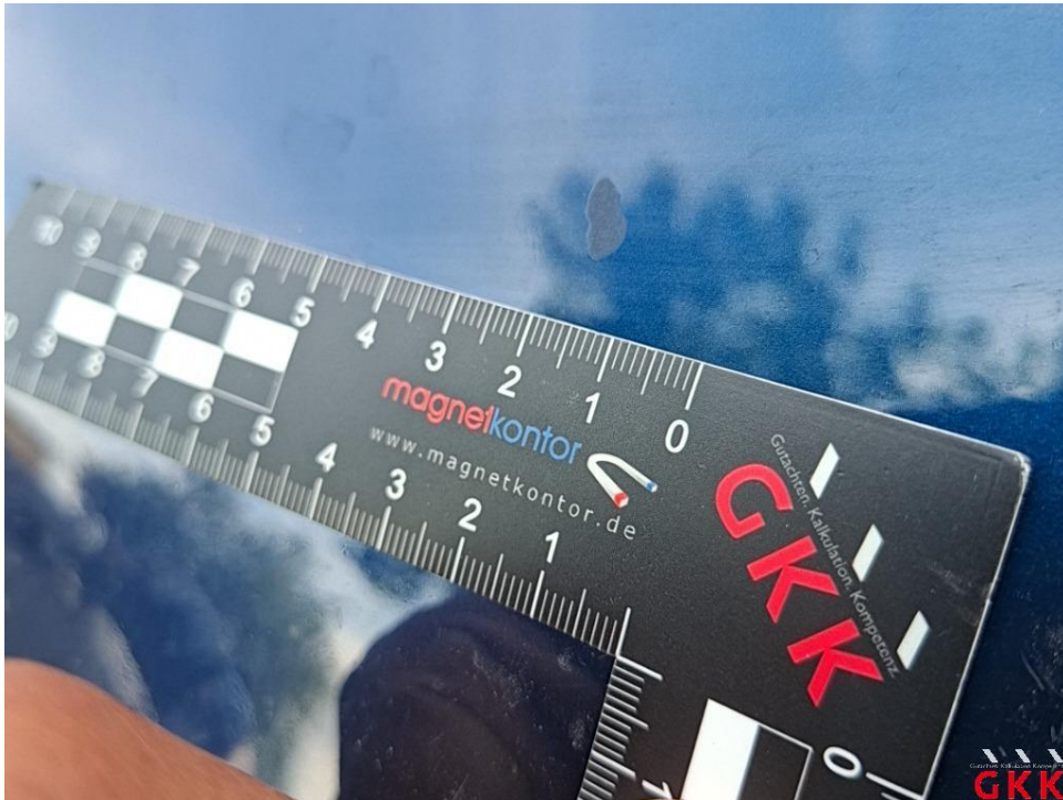
Bild 40. Kotflügel vorne rechts, Lackierung verätzt, lackieren
