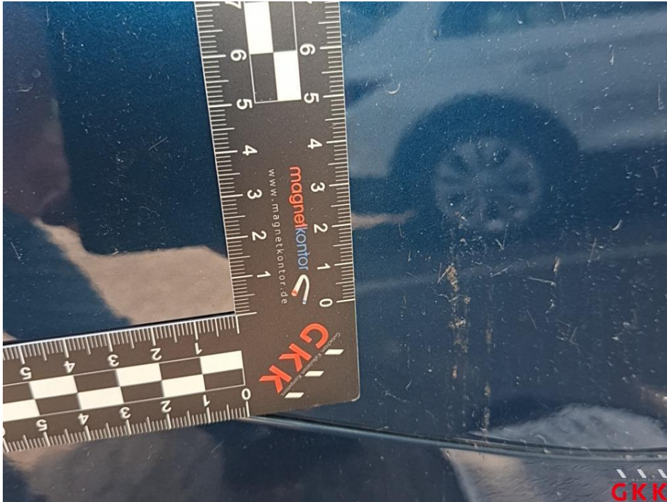
Bild 29. Seitenwand rechts, Lackierung verätzt, aufbereiten
