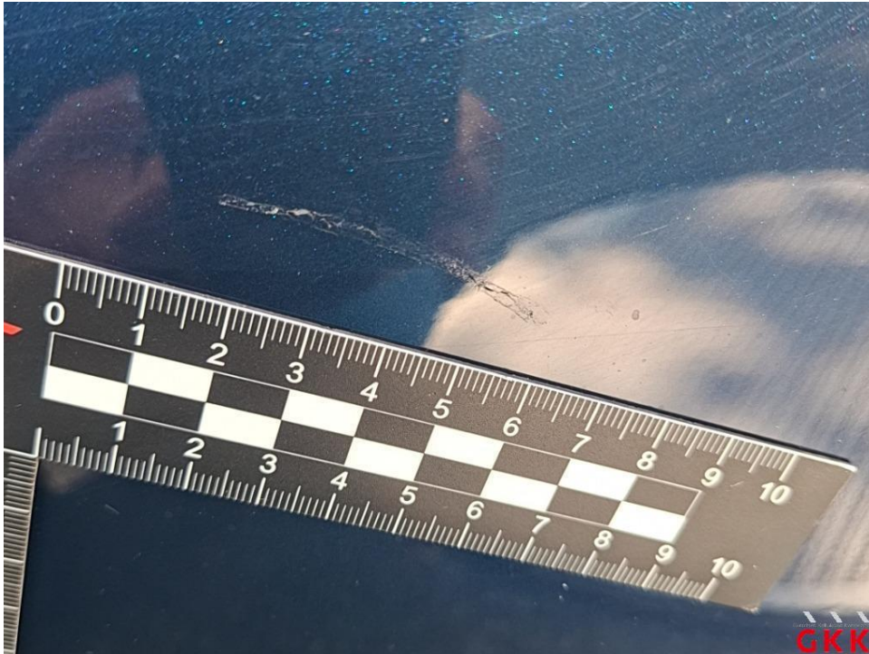
Bild 35. Tür vorne rechts, Lackierung verätzt, lackieren
