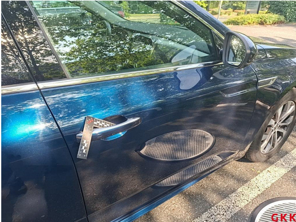
Bild 31. Tür vorne rechts, Griff, verkratzt, lackieren ohne LV
