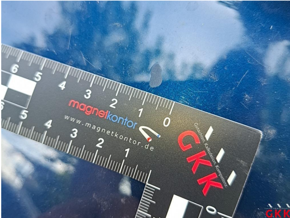
Bild 39. Kotflügel vorne rechts, Lackierung verätzt, lackieren
