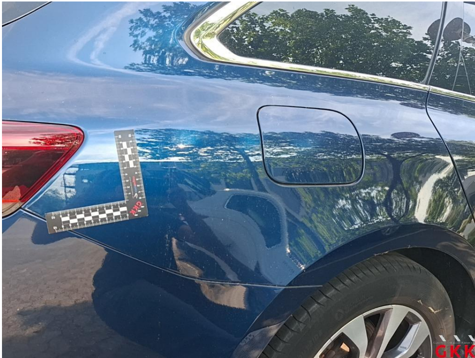
Bild 28. Seitenwand rechts, Lackierung verätzt, aufbereiten
