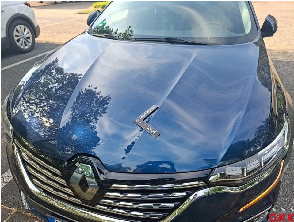
Bild 13. Motorhaube, Lackierung verätzt, aufbereiten
