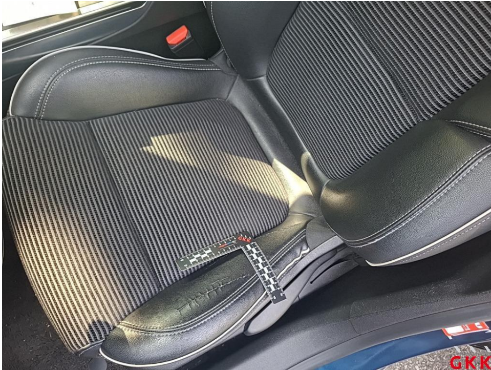
Bild 19. Sitz vorne links, Bezug Sitzkissen -Stoff-, beschädigt, ersetzen
