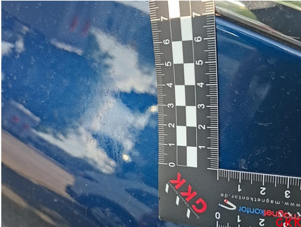
Bild 37. Tür hinten rechts, Lackierung verätzt, aufbereiten
