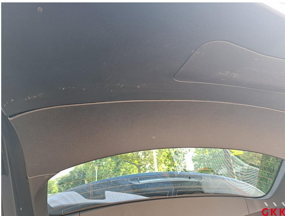
Bild 26. Heckklappe, Innenverkleidung, verkratzt, Smartrepair
