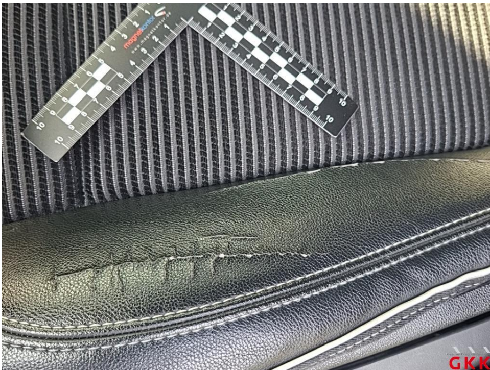
Bild 20. Sitz vorne links, Bezug Sitzkissen -Stoff-, beschädigt, ersetzen
