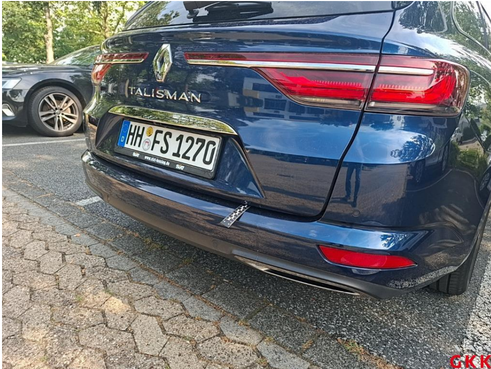
Bild 23. Stoßfänger hinten, Verkleidung -lackiert-, verkratzt, lackieren
