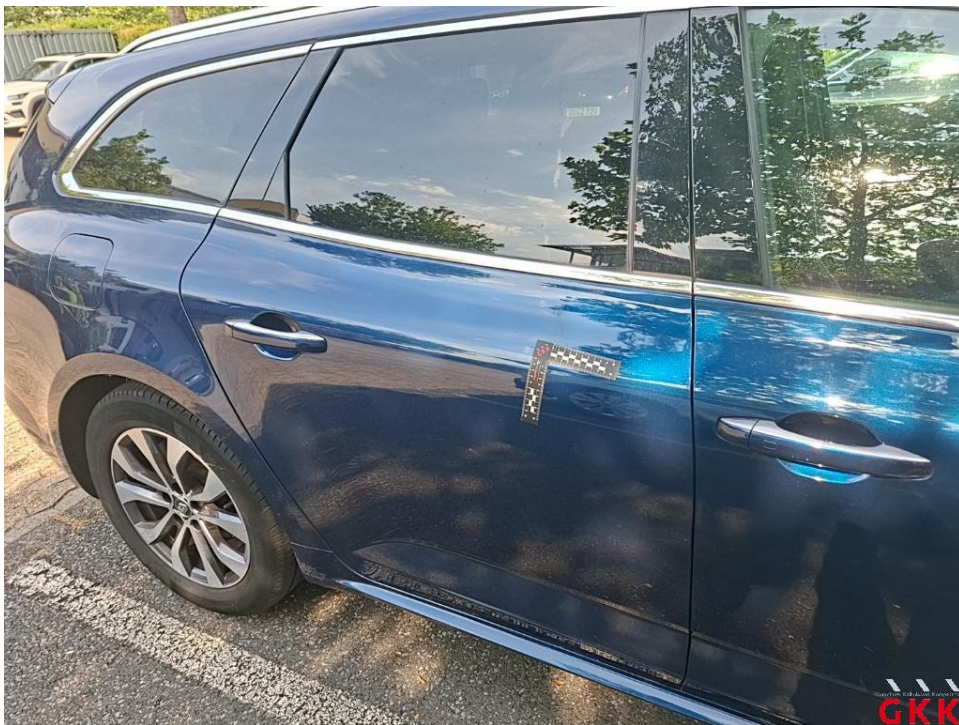
Bild 36. Tür hinten rechts, Lackierung verätzt, aufbereiten
