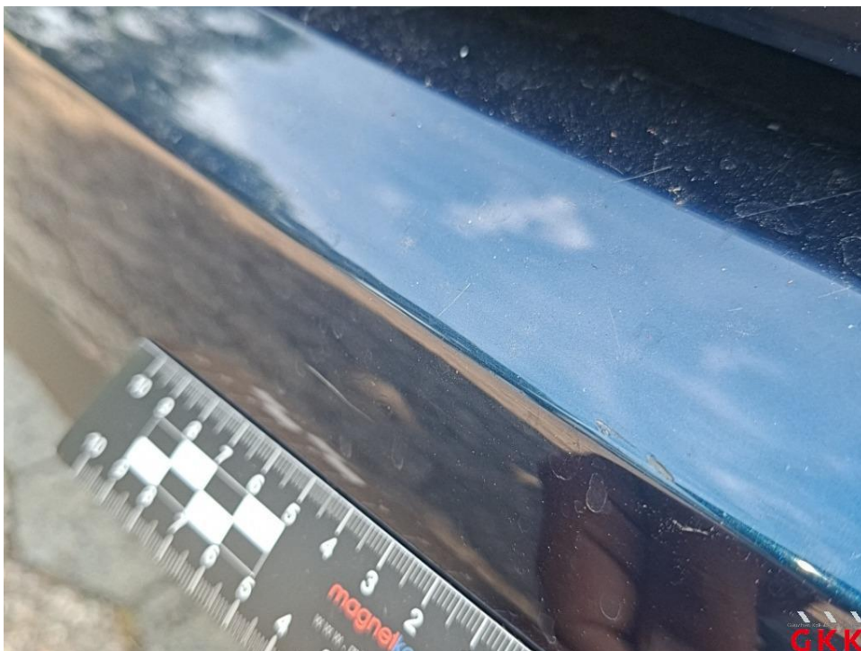
Bild 25. Stoßfänger hinten, Verkleidung -lackiert-, verkratzt, lackieren
