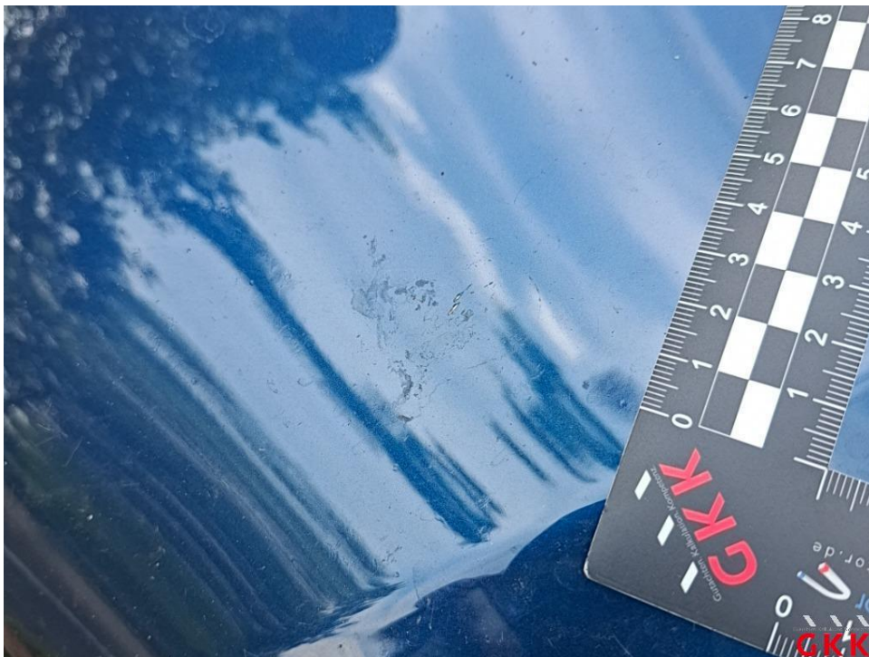
Bild 14. Motorhaube, Lackierung verätzt, aufbereiten
