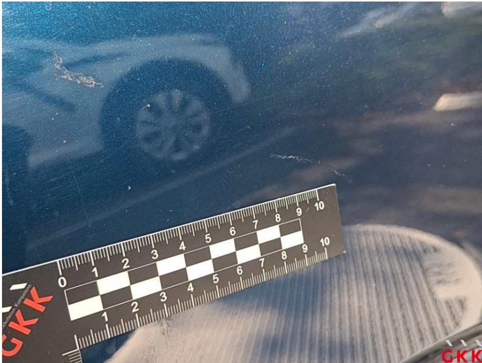
Bild 34. Tür vorne rechts, Lackierung verätzt, lackieren
