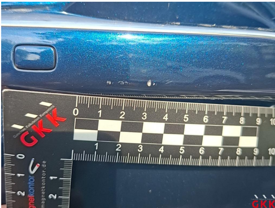
Bild 32. Tür vorne rechts, Griff, verkratzt, lackieren ohne LV
