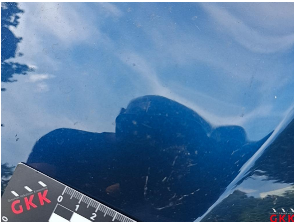
Bild 15. Motorhaube, Lackierung verätzt, aufbereiten
