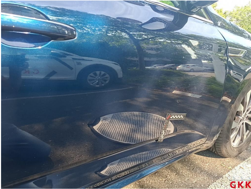
Bild 33. Tür vorne rechts, Lackierung verätzt, lackieren
