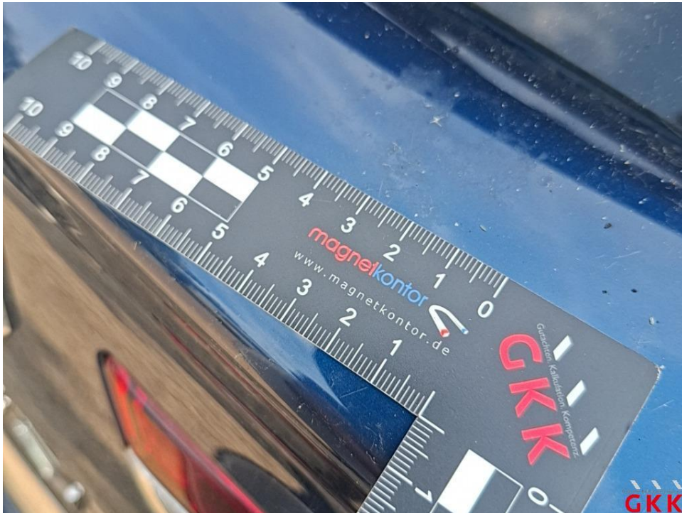
Bild 22. Heckklappe, Lackierung verätzt, aufbereiten
