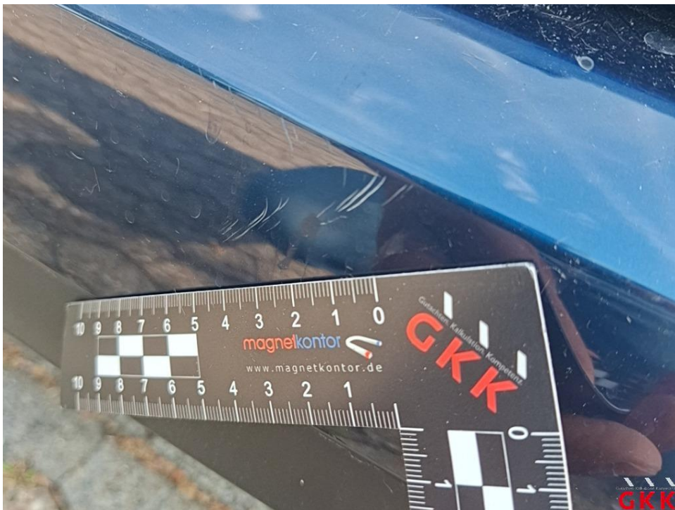
Bild 24. Stoßfänger hinten, Verkleidung -lackiert-, verkratzt, lackieren
