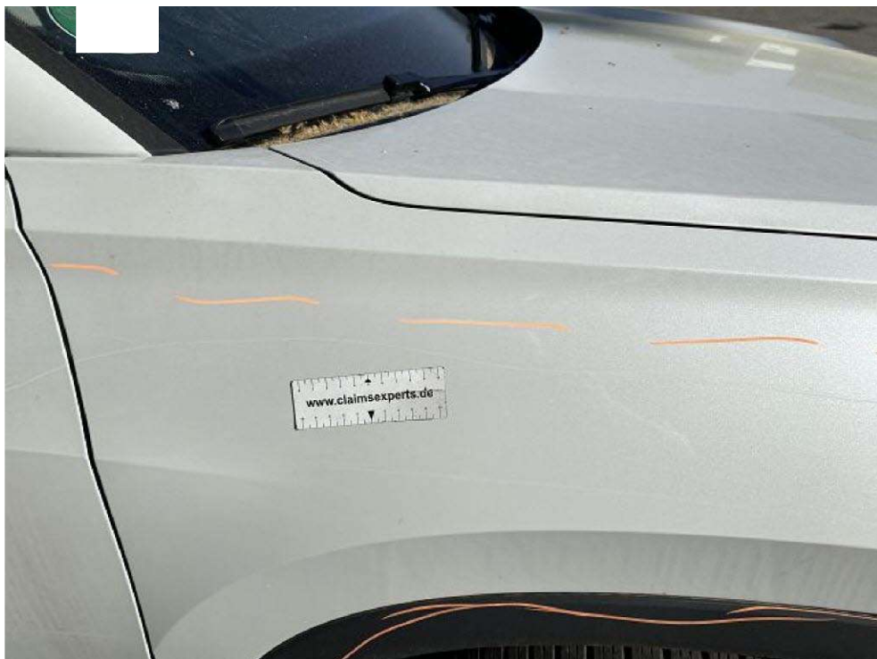
Bild 10 Detailansicht Kotflügel vorne rechts verkratzt
