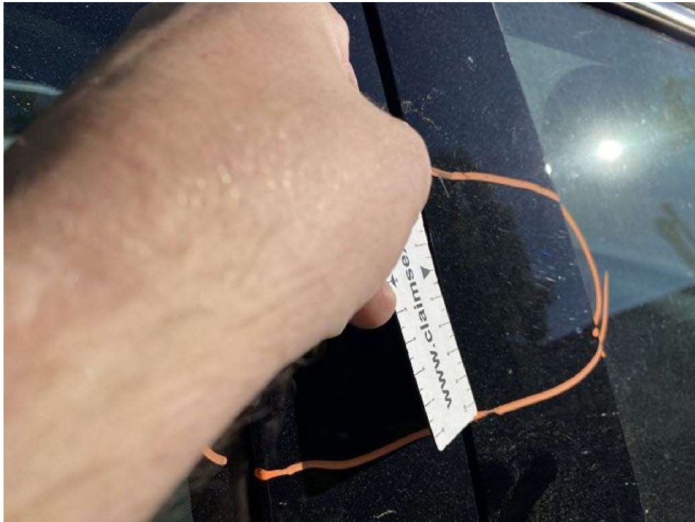
Bild 17 Detailansicht Blende Türen rechts verkratzt
