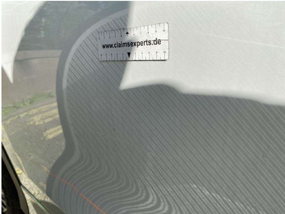
Bild 13 Detailansicht Tür hinten rechts verkratzt
