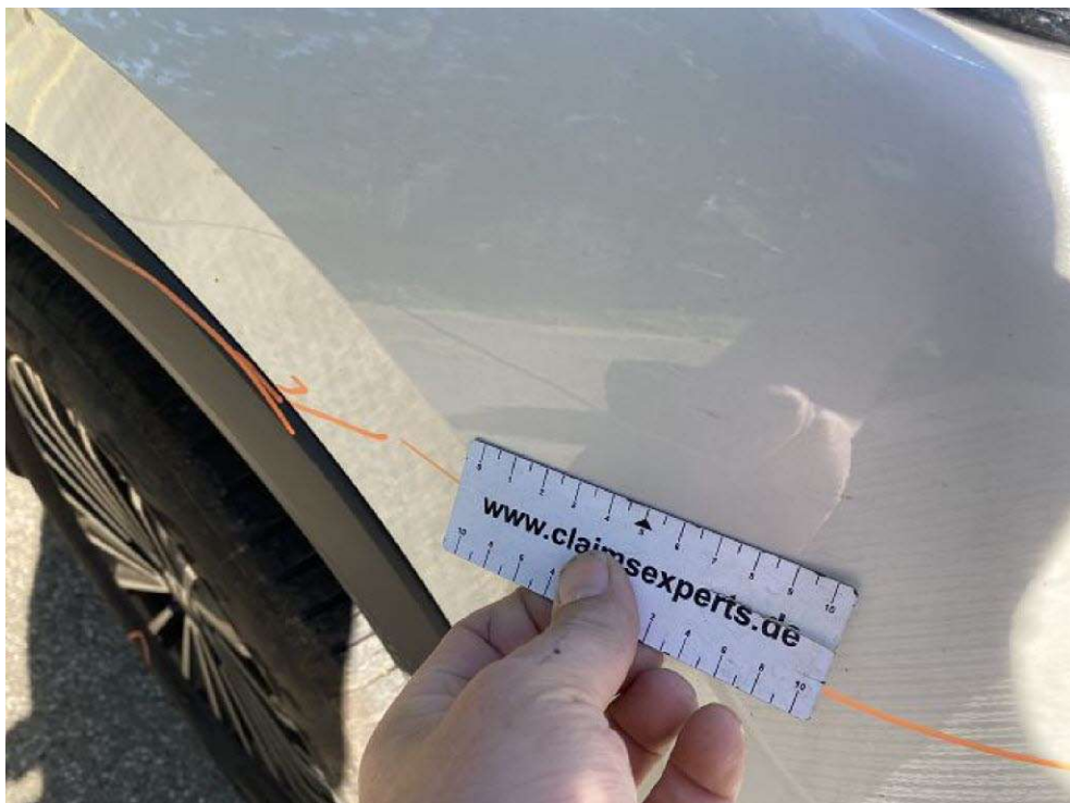
Bild 8 Detailansicht Stoßfängerverkleidung vorne verkratzt
