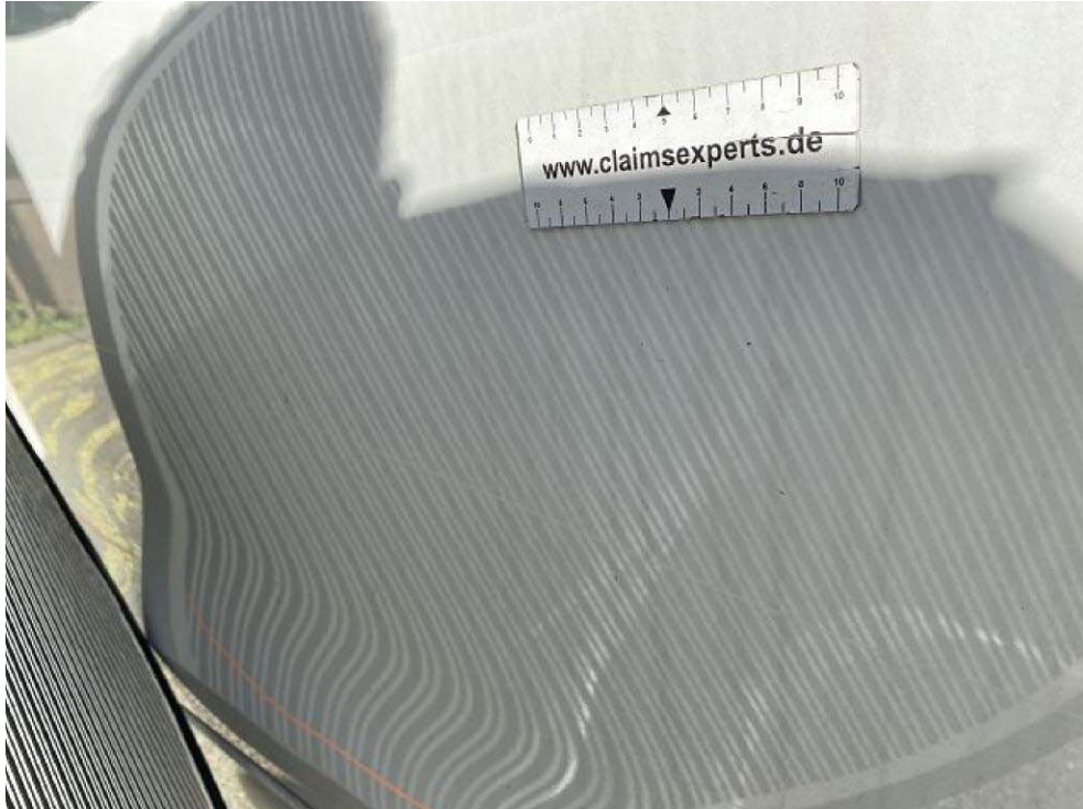
Bild 12 Detailansicht Tür vorne rechts verkratzt
