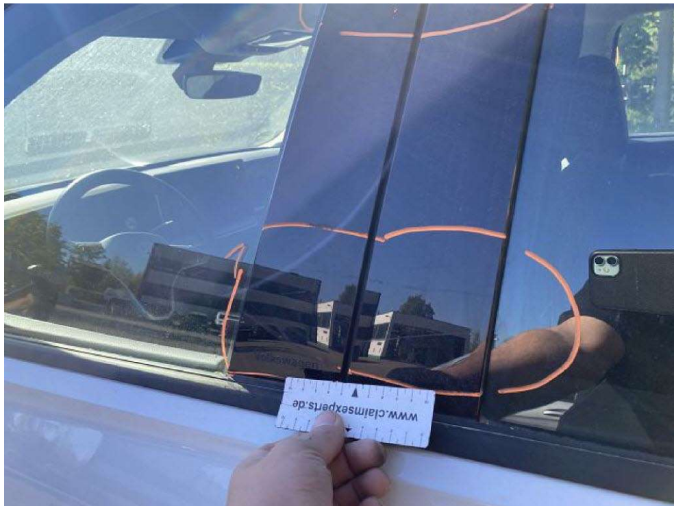
Bild 21 Detailansicht Blende Türen links verkratzt
