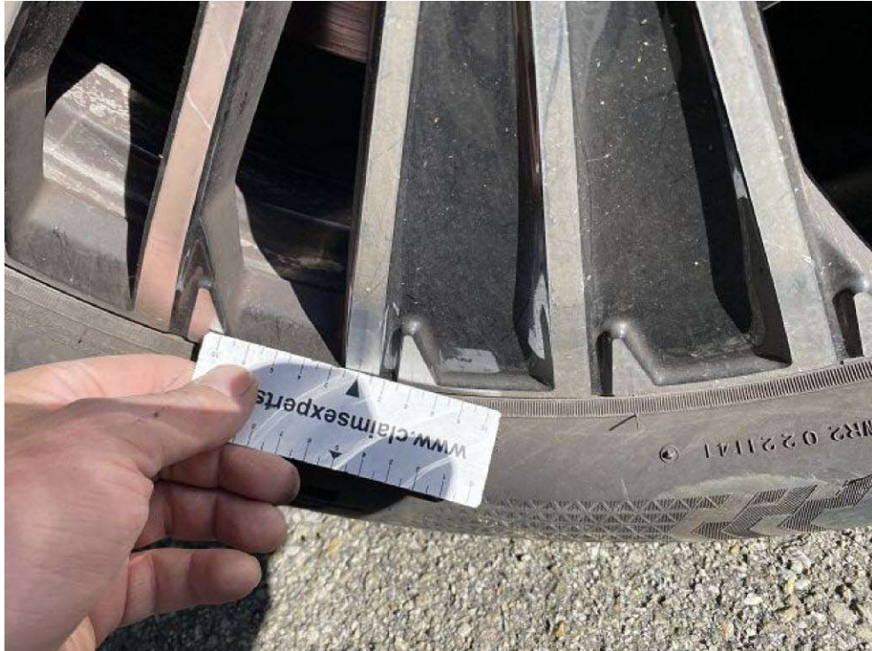
Bild 20 Detailansicht Felge verschrammt
