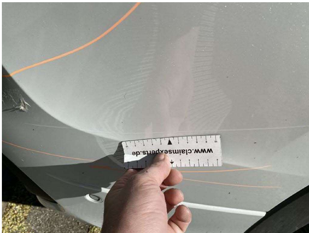
Bild 16 Detailansicht Stoßfängerverkleidung hinten verkratzt
