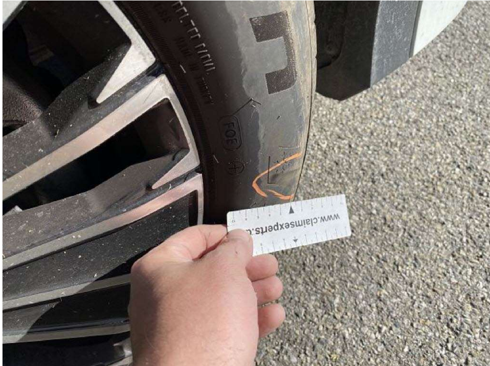
Bild 18 Detailansicht Reifen verschrammt
