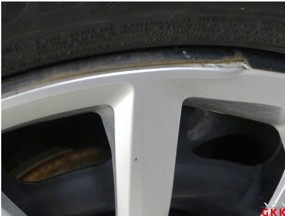
Bild 14 Radkappe(n), Satz, beschädigt, ersetzen
