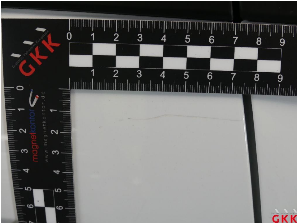
Bild 21 Tür hinten rechts, verkratzt, lackieren
