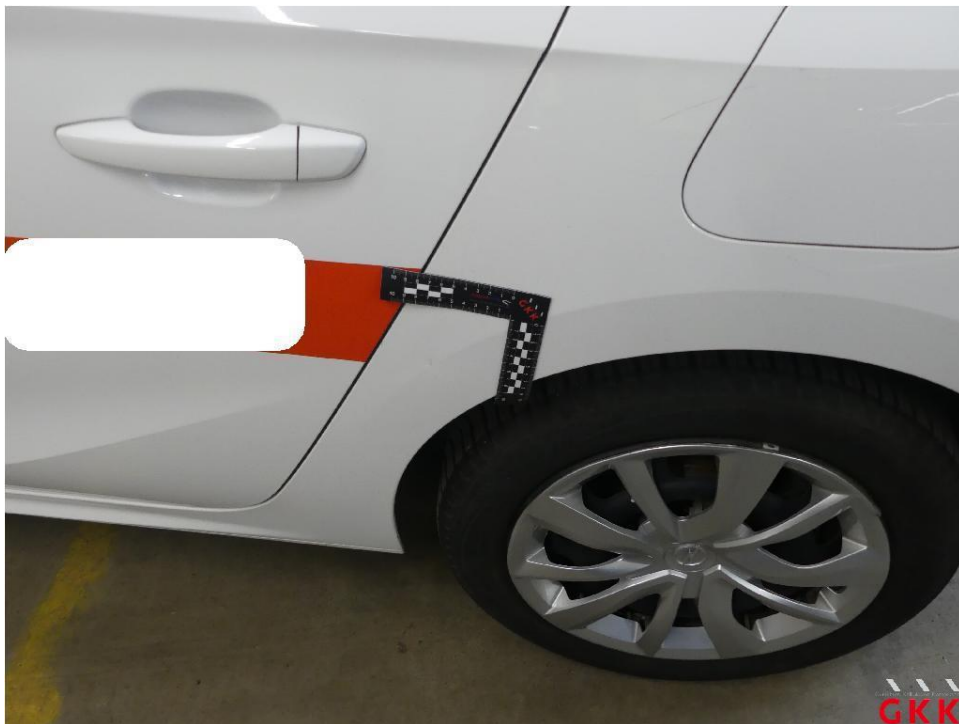
Bild 22 Seitenwand links, beschädigt, instand setzen - lackieren
