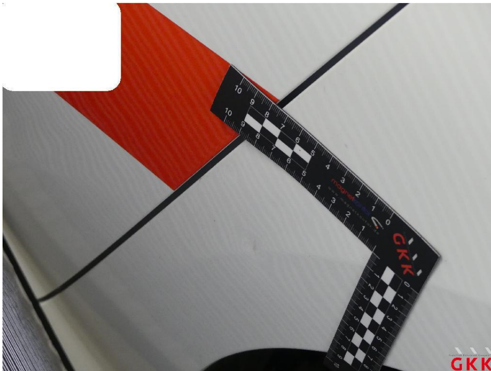
Bild 23 Seitenwand links, beschädigt, instand setzen - lackieren
