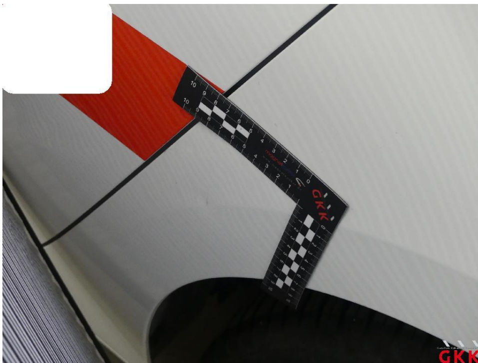
Bild 24 Seitenwand links, beschädigt, instand setzen - lackieren
