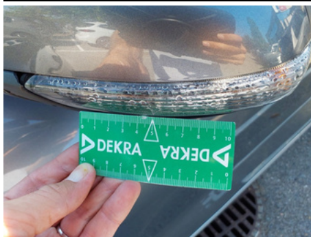
Feu clignotant / Gauche / Cassé
