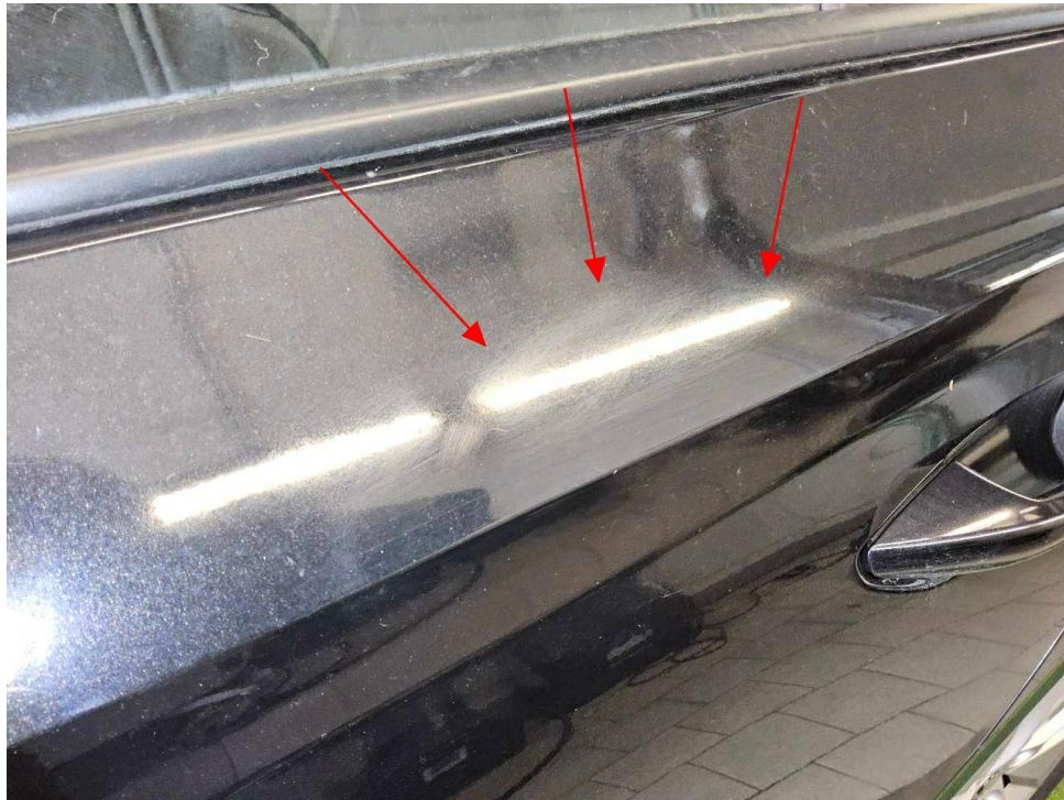
Bild 27 : Tür hinten links Schleifspuren am Bauteil
