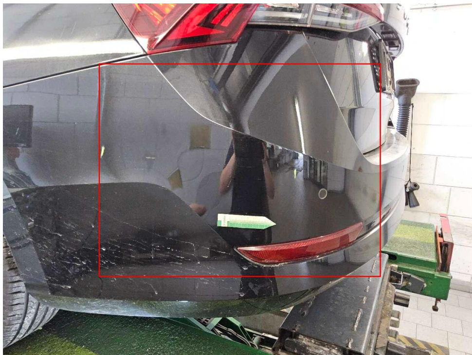
Bild 14 : Stoßfänger hinten verschrammt
