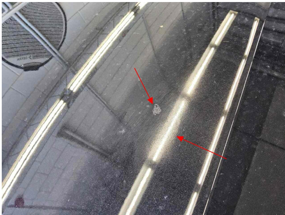
Bild 24 : Motorhaube Lackverätzungen, Schleifspuren am Bauteil zu erkennen
