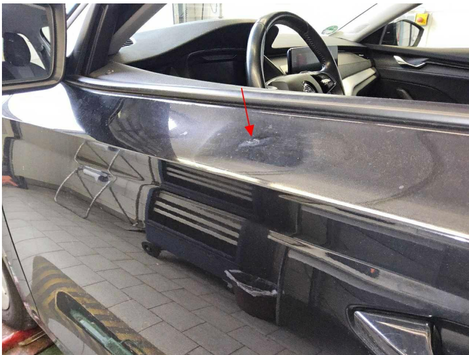
Bild 30 : Tür vorne links Lackverätzungen, Schleifspuren
