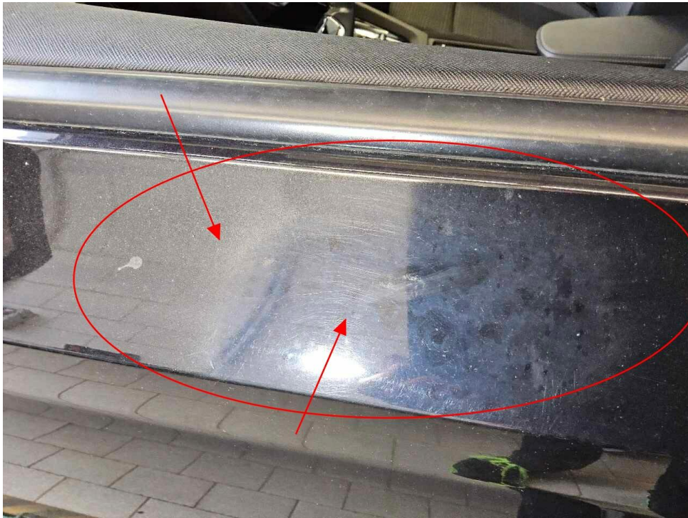
Bild 29 : Tür vorne links Lackverätzungen, Schleifspuren
