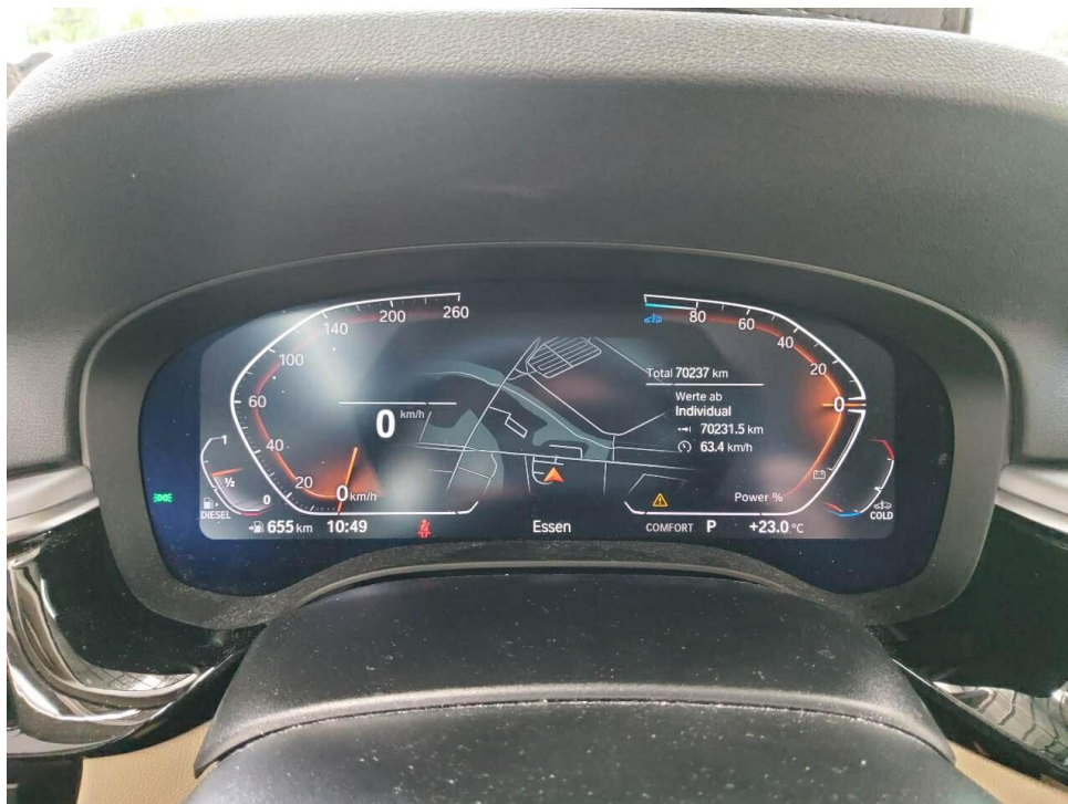
Bild 6 : Kombiinstrument (betriebsbereit) mit Km-Stand
