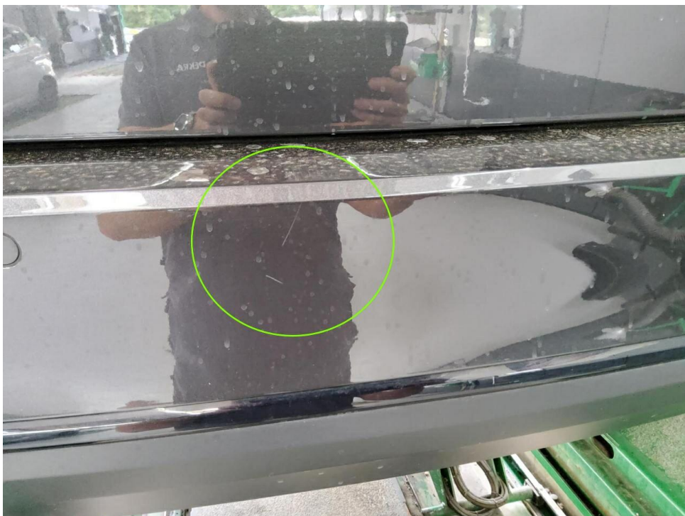
Bild 16 : Stoßfänger hinten Lackierung, zerkratzt, polieren
