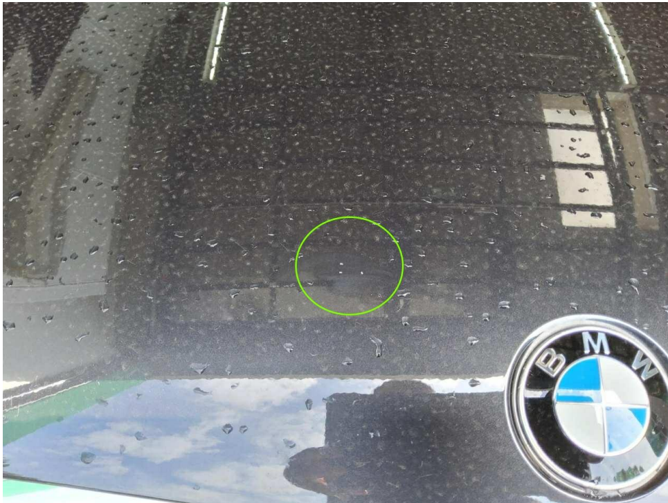
Bild 15 : Motorhaube Lackierung, Steinschlag, Gebrauchsspur
