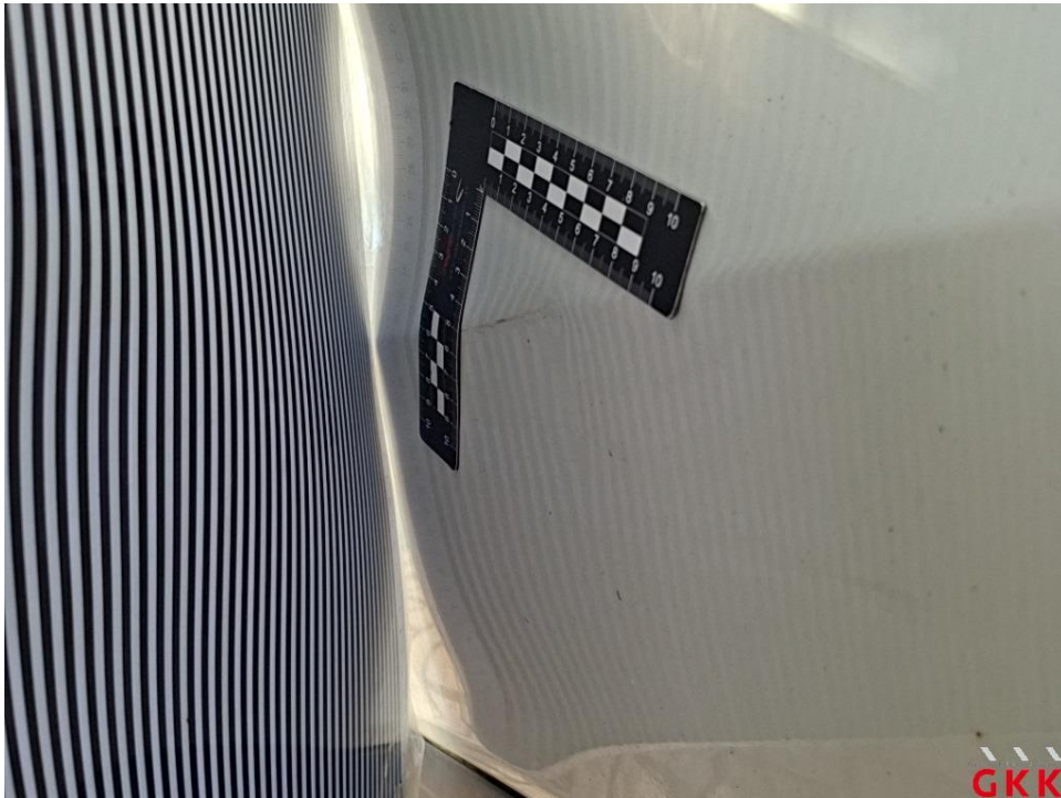
Bild 19. Seitenwand links, vorne, beschädigt, instand setzen - lackieren
