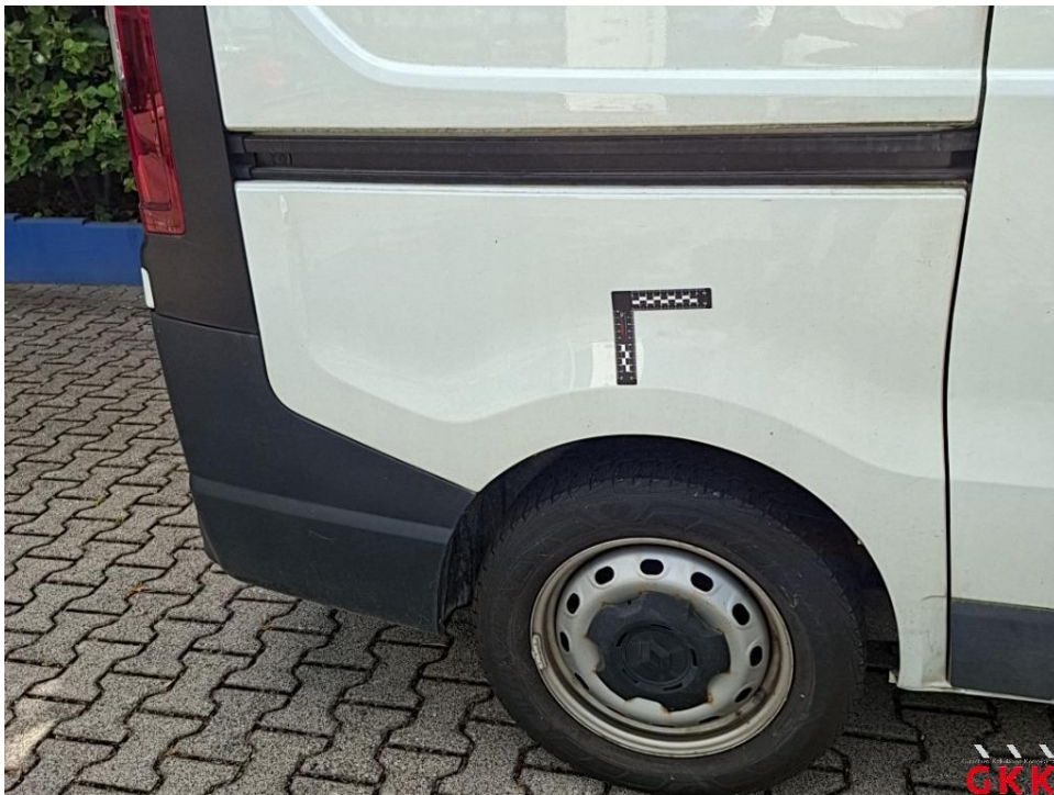
Bild 20. Seitenwand rechts, unterhalb, beschädigt, instand setzen - lackieren
