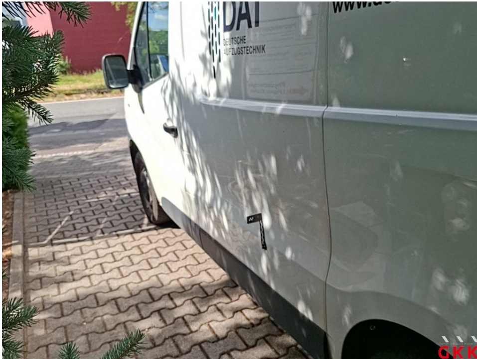
Bild 17. Seitenwand links, vorne, beschädigt, instand setzen - lackieren
