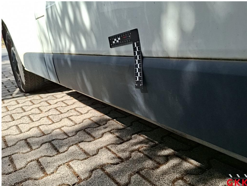
Bild 26. Seitenwand links, Leiste -unten-, beschädigt, ersetzen
