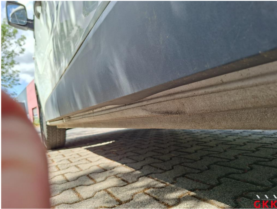
Bild 31. Schweller links, beschädigt, instand setzen - lackieren
