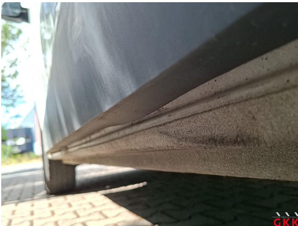
Bild 28. Seitenwand links, Leiste -unten-, beschädigt, ersetzen
