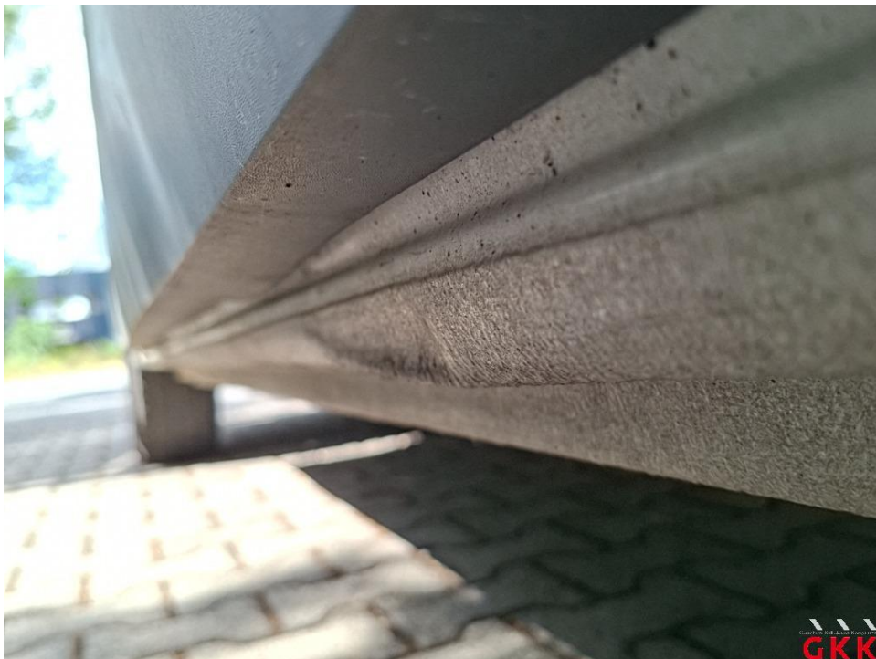
Bild 30. Schweller links, beschädigt, instand setzen - lackieren
