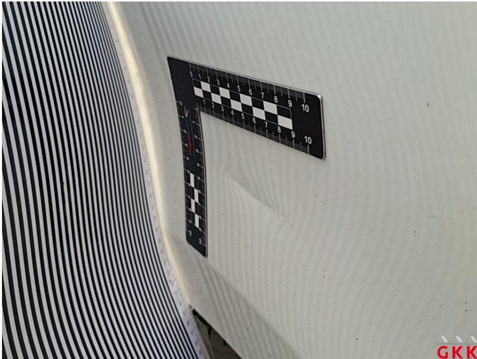
Bild 21. Seitenwand rechts, unterhalb, beschädigt, instand setzen - lackieren
