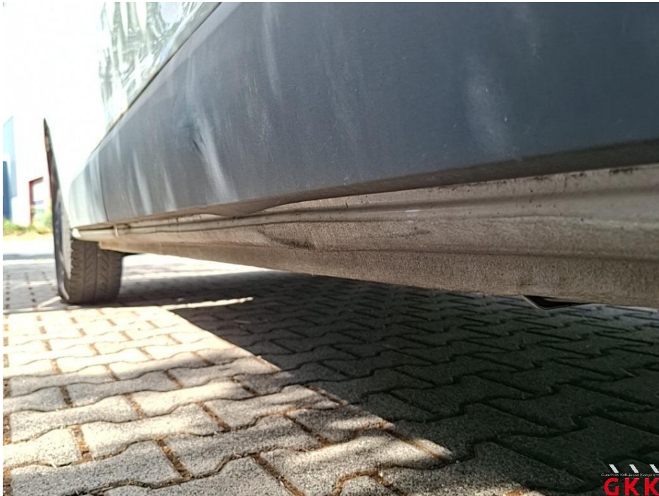
Bild 29. Schweller links, beschädigt, instand setzen - lackieren
