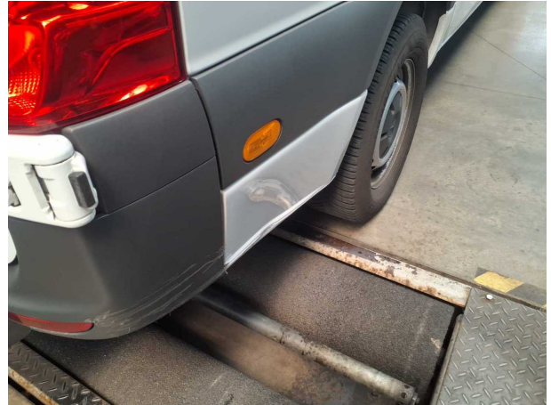
Beschädigung #12: Seitenwand rechts: Seitenwand (Bepankung unten hinten) - verformt - instandsetzen/lackieren (S1)
