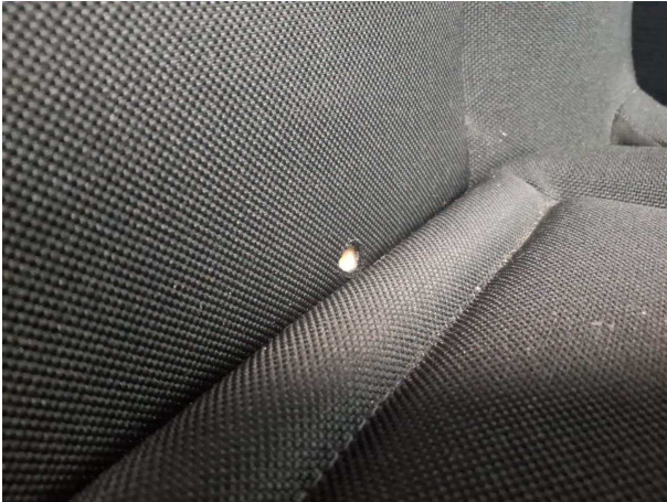
Beschädigung #11: Sitz vorn: Lehnenbezug rechts - Brandloch - erneuern
