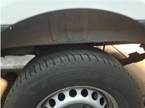
Beschädigung #9: Rad/Reifen: Reifen hinten links - verschlissen - erneuern
