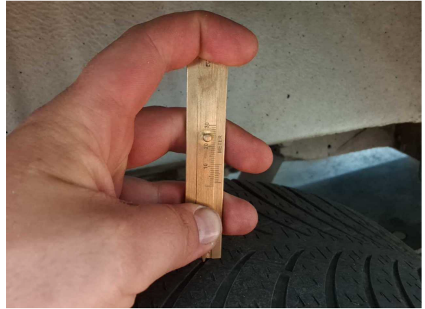
Beschädigung #8: Rad/Reifen: Reifen hinten rechts - verschlissen - erneuern
