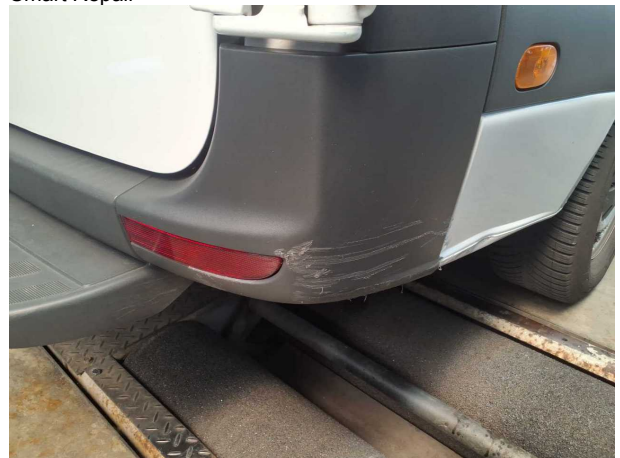
Beschädigung #4: Stossfänger hinten: Stossfänger hinten rechts - verkratzt / verschürft - erneuern
