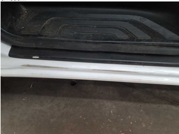
Beschädigung #10: Schweller links: Einstieg - verkratzt / verschürft - lackieren
