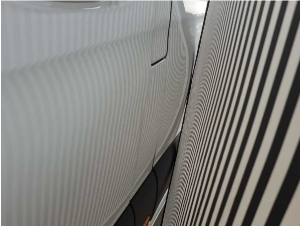
Beschädigung #5: Kraftstoffanlage: Tankklappe - verformt - erneuern
