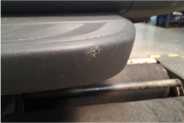
Beschädigung #14: Stossfänger hinten: Stossfänger Auftritt mit Parktronic (komplett) - verformt - erneuern
