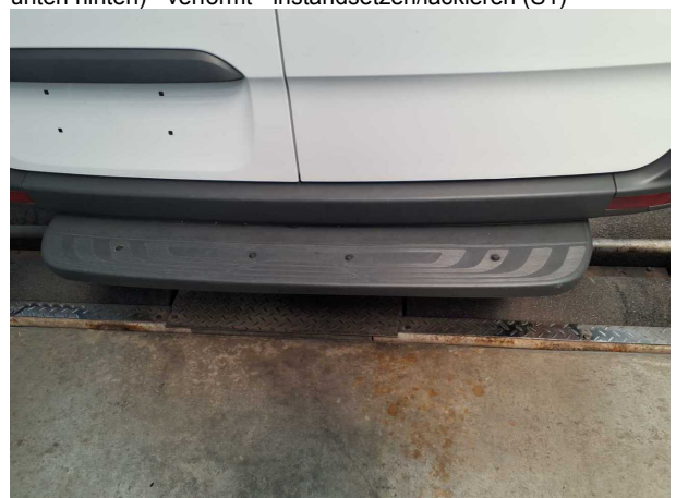
Beschädigung #14: Stossfänger hinten: Stossfänger Auftritt mit Parktronic (komplett) - verformt - erneuern
