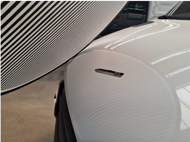
Beschädigung #6: Motorhaube: Motorhaube - Delle(n) - Smart Repair
