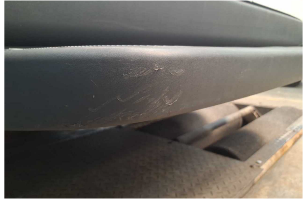
Beschädigung #14: Stossfänger hinten: Stossfänger Auftritt mit Parktronic (komplett) - verformt - erneuern
