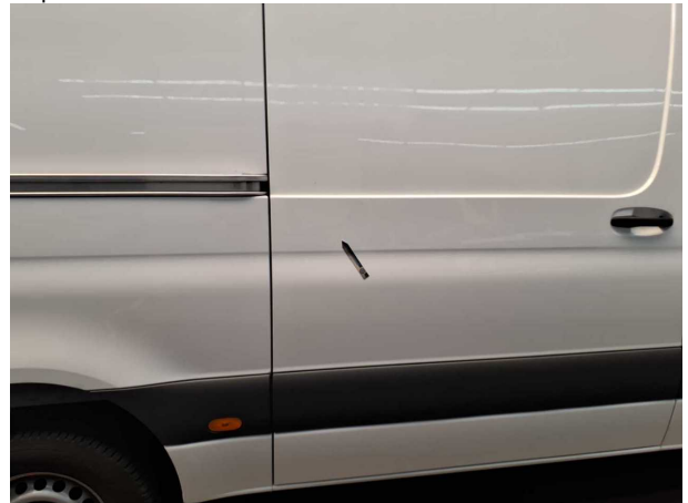
Beschädigung #7: Schiebetür rechts: Schiebetür - Delle(n) - Sm... Repair
