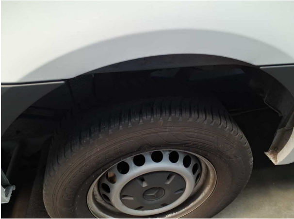
Beschädigung #8: Rad/Reifen: Reifen hinten rechts - verschlissen - erneuern
