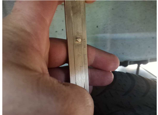
Beschädigung #9: Rad/Reifen: Reifen hinten links - verschlissen - erneuern
