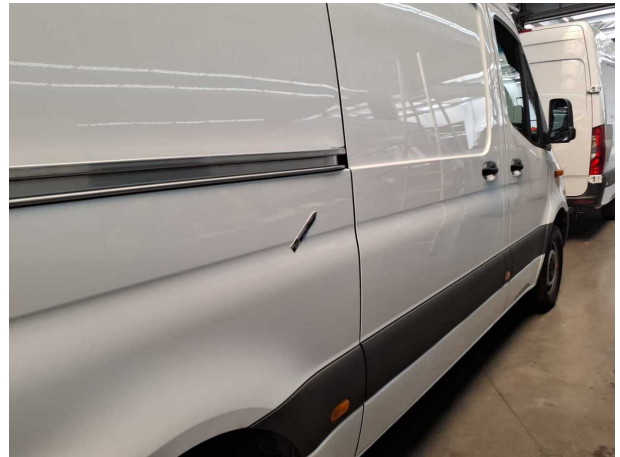
Beschädigung #3: Seitenwand rechts: Seitenwand - Delle(n) - Smart Repair
