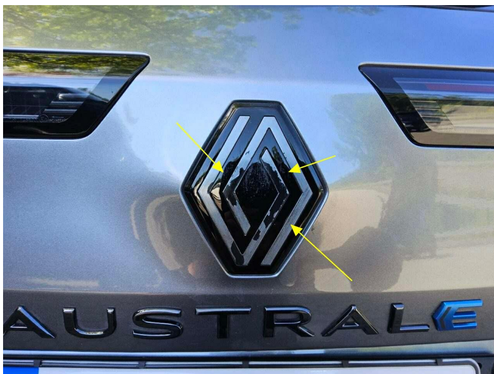
Bild 10 : Lackablösung am hinteren Markenzeichen
