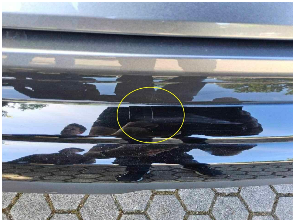
Bild 12 : Stoßfängerverkleidung hinten verkratzt
