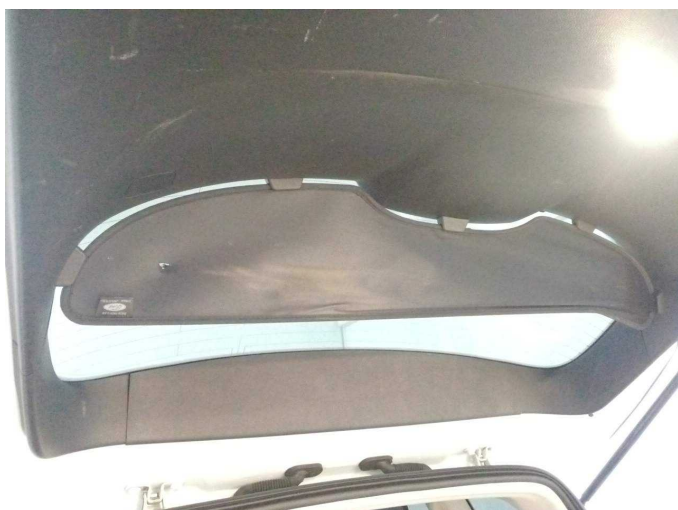
Damage 6: Misc.: Misc. (Sonenblende Heck) - Holes - Replace
