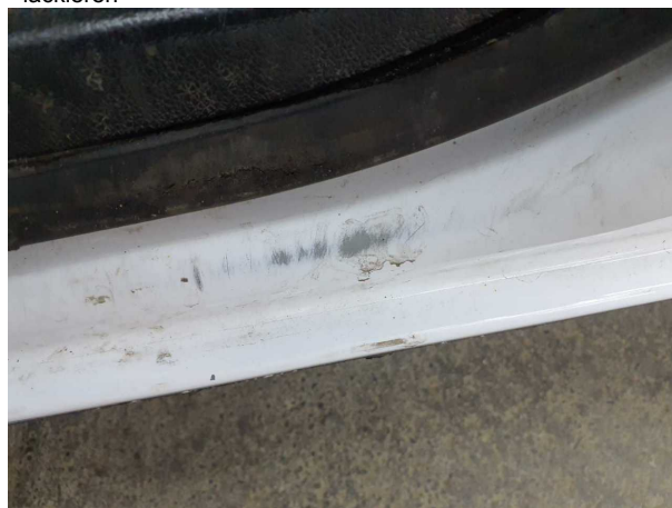
Beschädigung #5: Schweller links: Einstieg - verkratzt / verschürft - lackieren
