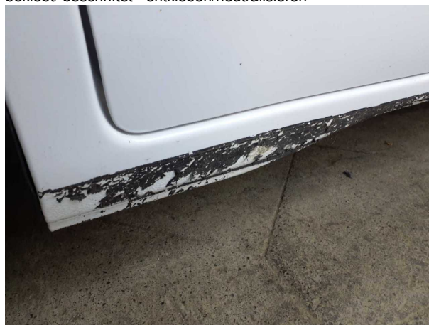
Beschädigung #3: Schweller links: Schweller (Klebe reste) - beklebt/ beschriftet - entkleben/neutralisieren
