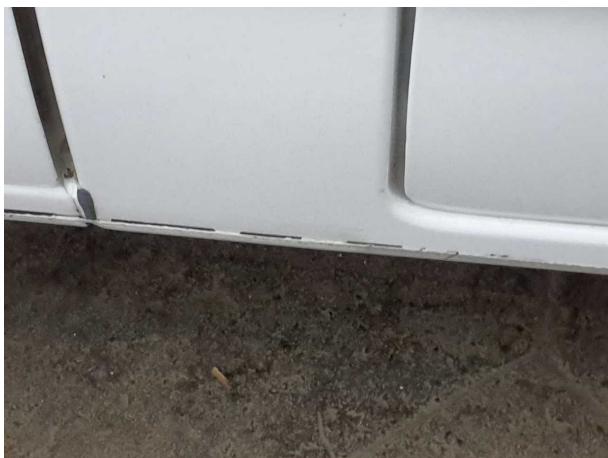
Beschädigung #4: Schweller rechts: Schweller (Klebe reste) - beklebt/ beschriftet - entkleben/neutralisieren
