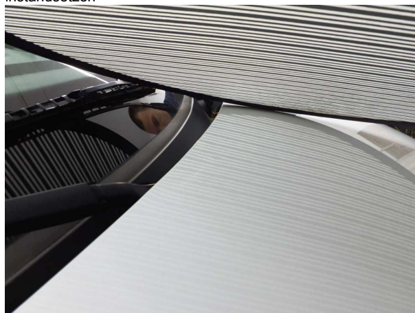
Beschädigung #2: Motorhaube: Motorhaube - Delle(n) - sanft instandsetzen
