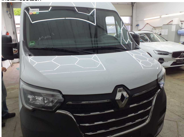
Beschädigung #2: Motorhaube: Motorhaube - Delle(n) - sanft instandsetzen
