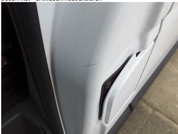
Beschädigung #5: Schweller links: Einstieg - verkratzt / verschürft - lackieren
