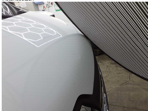
Beschädigung #2: Motorhaube: Motorhaube - Delle(n) - sanft instandsetzen
