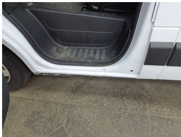
Beschädigung #5: Schweller links: Einstieg - verkratzt / verschürft - lackieren
