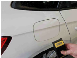
Lackstärke Seitenwand hinten rechts
