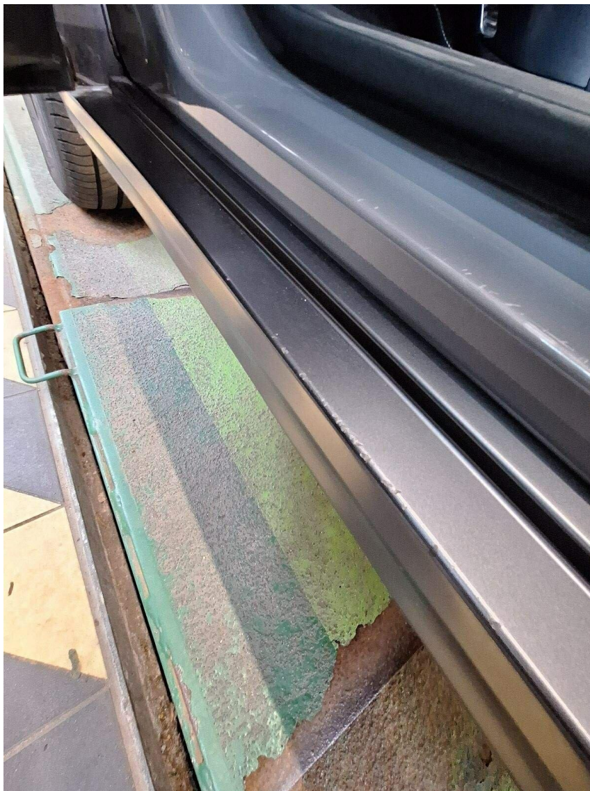
Bild 8 : Schweller vorne links Kratzer
