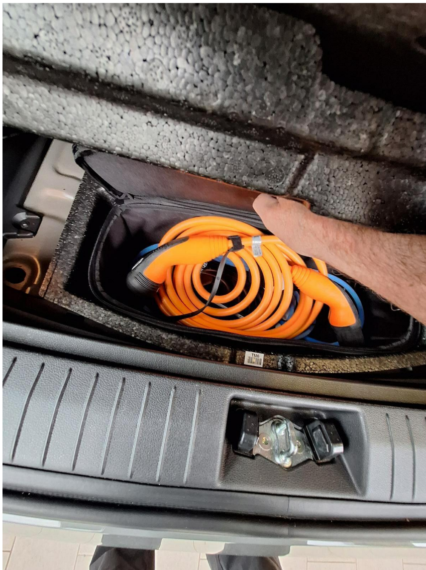
Bild 6 : Ladekabel beim E-Fahrzeug
