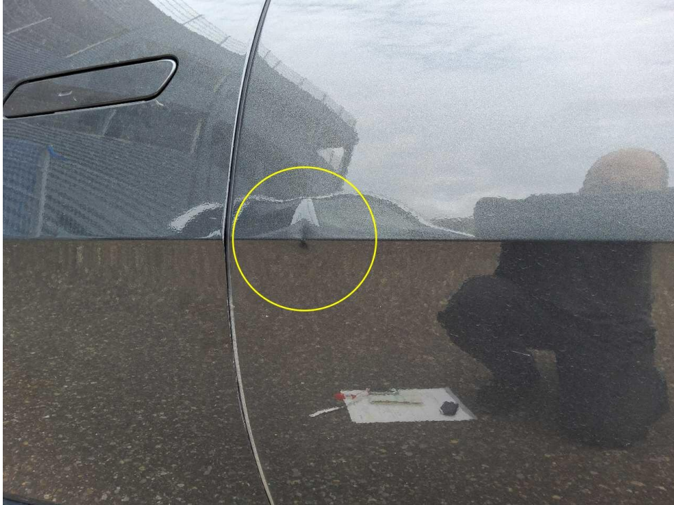
Bild 15 : Tür hinten links Parkdelle
