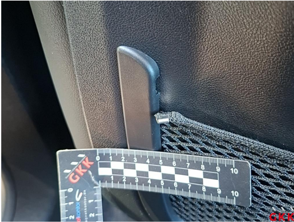
Bild 37. Sitz vorne links, Verkleidung, beschädigt, ersetzen
