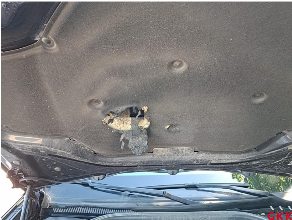
Bild 12. Motorhaube, Dämmmatte, beschädigt, ersetzen
