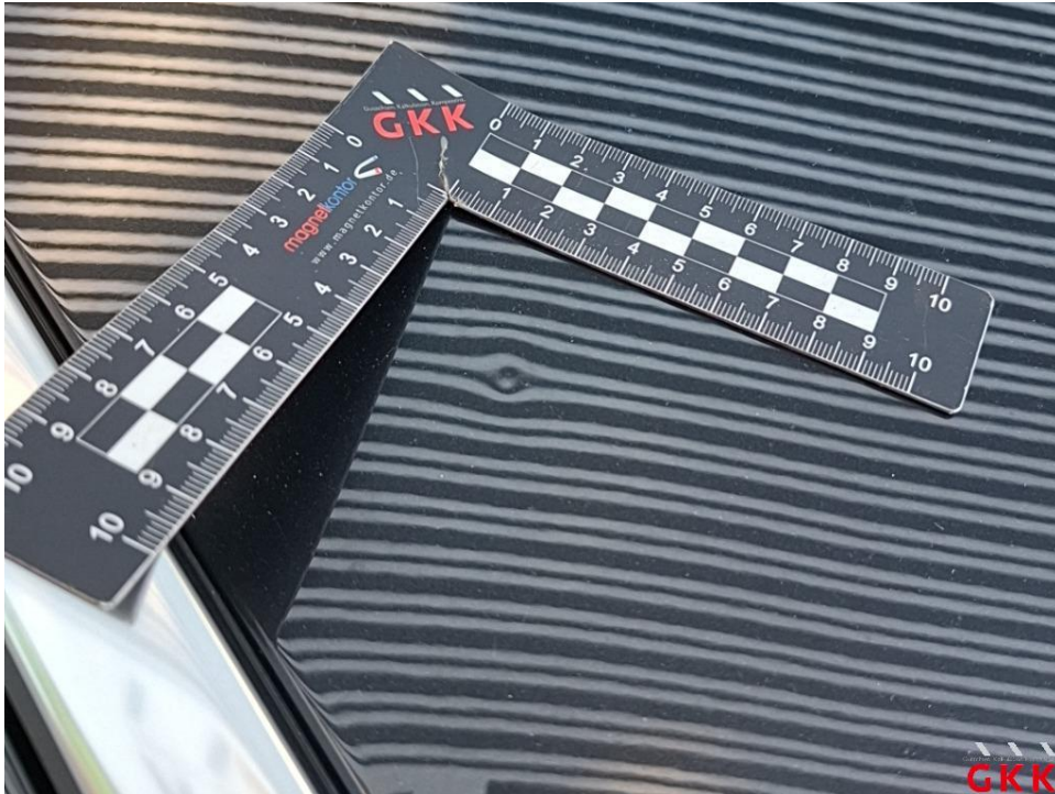
Bild 21. Dach, bis 3 Dellen / Bauteil, kalt drücken
