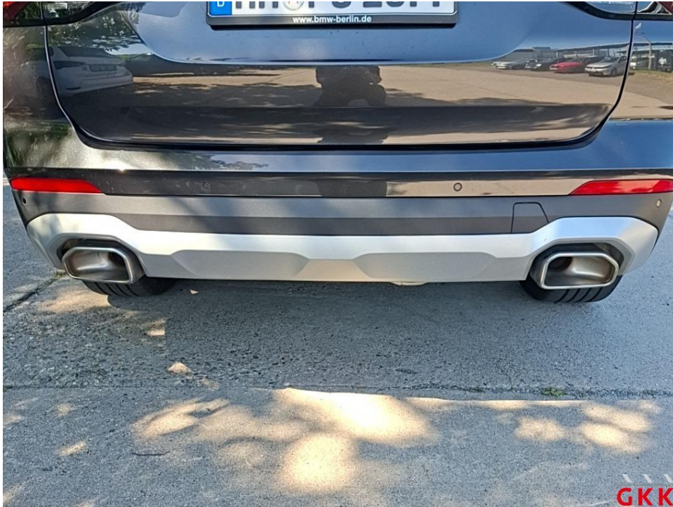
Bild 17. Stoßfänger hinten, Leiste -mittig-, beschädigt, ersetzen
