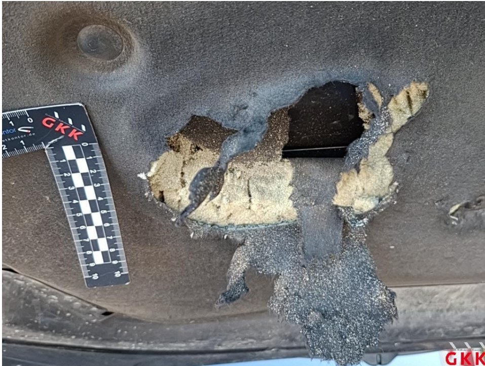
Bild 13. Motorhaube, Dämmmatte, beschädigt, ersetzen
