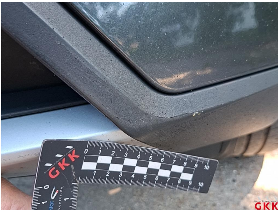
Bild 30. Stoßfänger vorne, Leiste -mittig-, beschädigt, ersetzen
