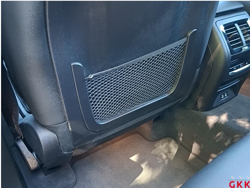
Bild 36. Sitz vorne links, Verkleidung, beschädigt, ersetzen
