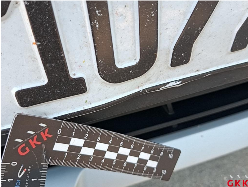
Bild 39. Kennzeichen vorne, beschädigt, ersetzen
