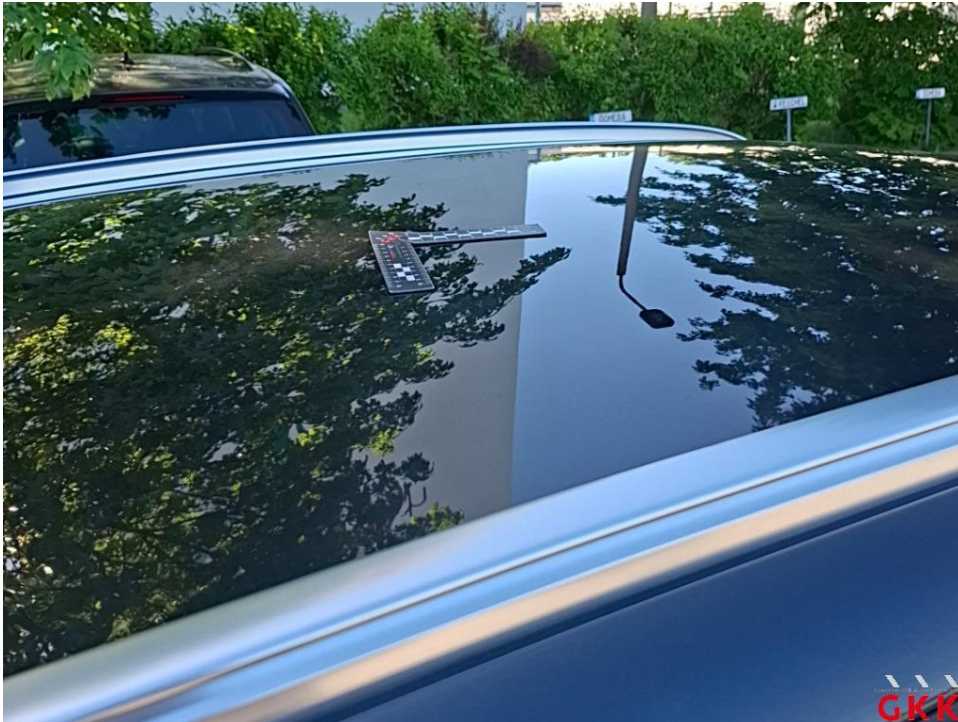
Bild 19. Dach, bis 3 Dellen / Bauteil, kalt drücken
