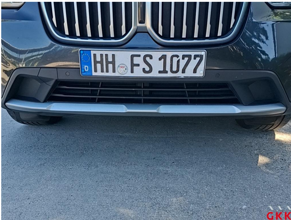
Bild 28. Stoßfänger vorne, Leiste -mittig-, beschädigt, ersetzen
