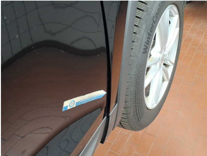
Damage 2: Mudguard - right side: Mudguard - right side (Mehrkosten möglich) - Malposition - Un- / install
