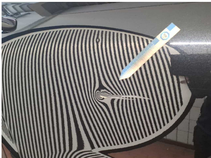
Damage 10: Door - rear right side: Door (+ Zierleiste unten erneuer) - Deformed - Replace
