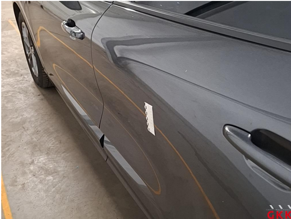
Bild 19 Tür hinten links, beschädigt, instand setzen - lackieren
