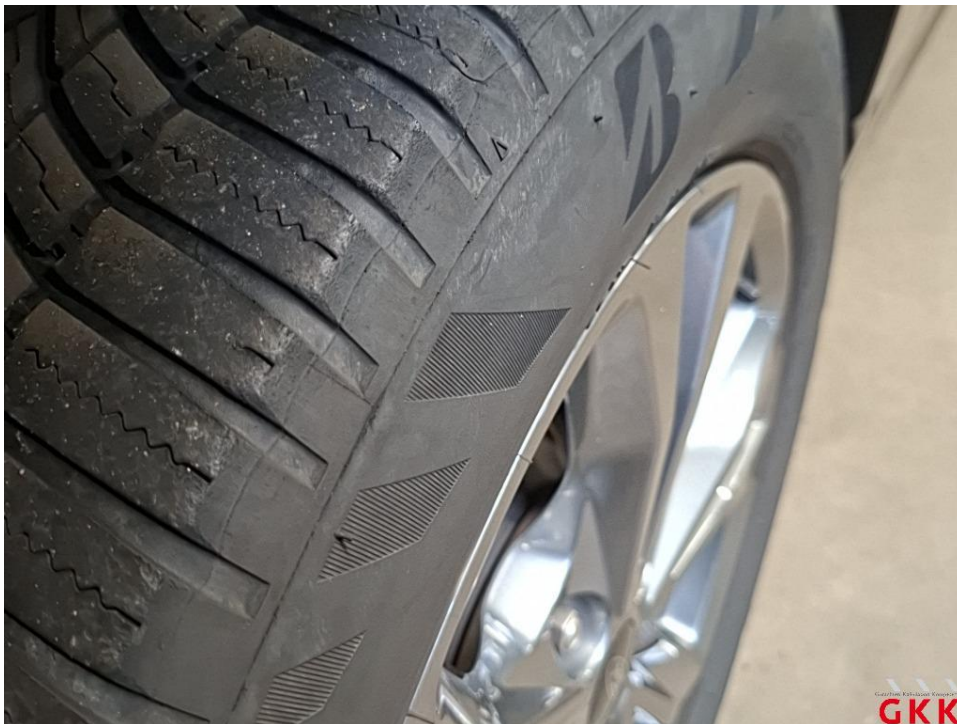
Bild 38 Reifen, hinten links und rechts, einseitig abgefahren, ersetzen
