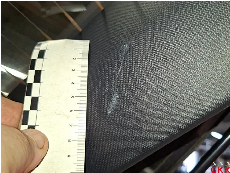
Bild 29 Heckklappe, Blende -unlackiert-, beschädigt, ersetzen
