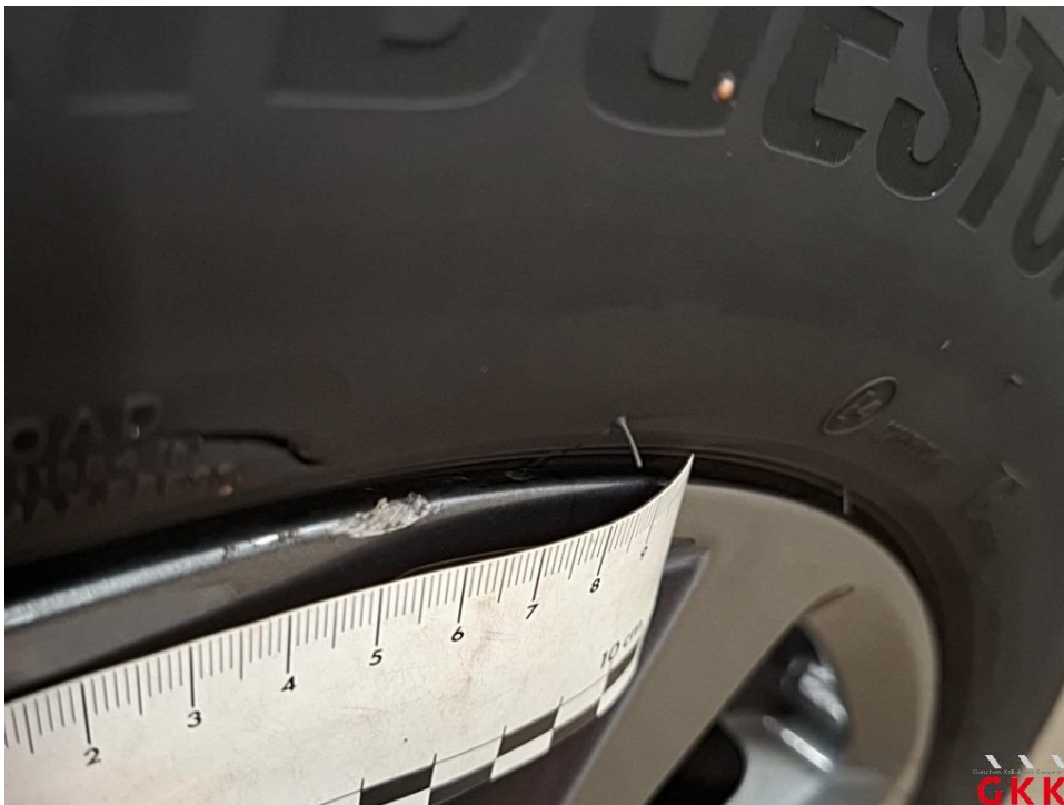
Bild 16 LM-Rad, vorne rechts, Materialabtrag, ersetzen
