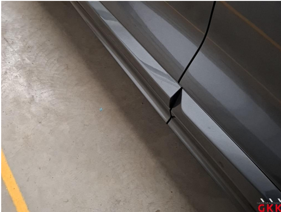
Bild 17 Tür vorne links, Leiste unten -lackiert-, beschädigt, lackieren
