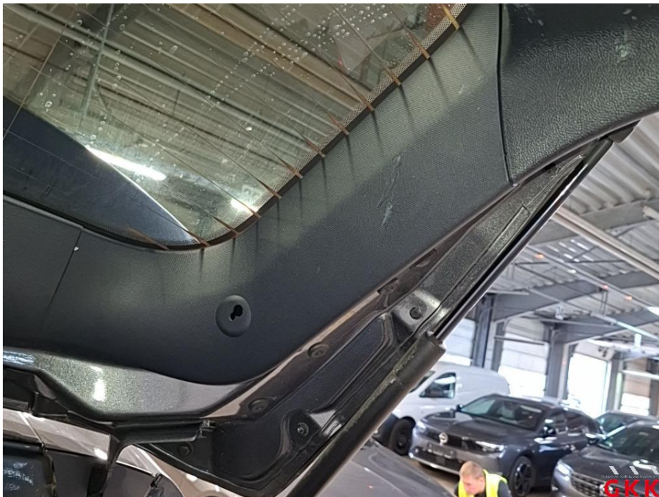
Bild 28 Heckklappe, Blende -unlackiert-, beschädigt, ersetzen
