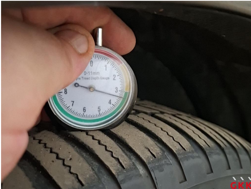
Bild 37 Reifen, vorn links und rechts, Untermaß, ersetzen
