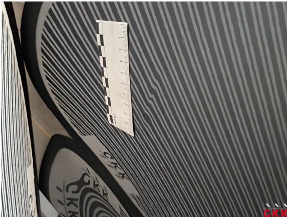
Bild 20 Tür hinten links, beschädigt, instand setzen - lackieren
