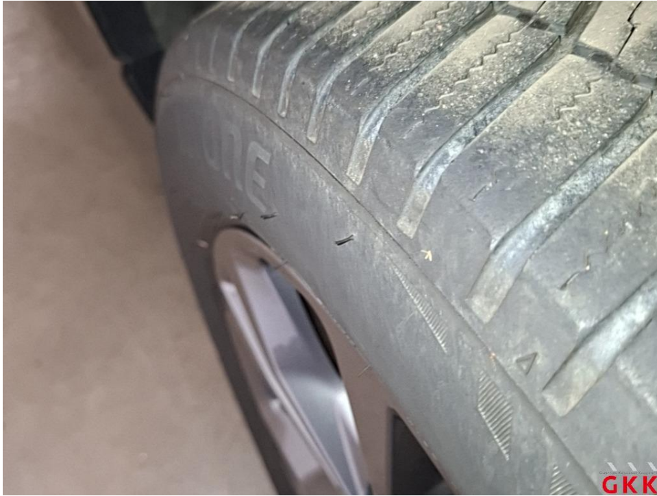
Bild 39 Reifen, hinten links und rechts, einseitig abgefahren, ersetzen
