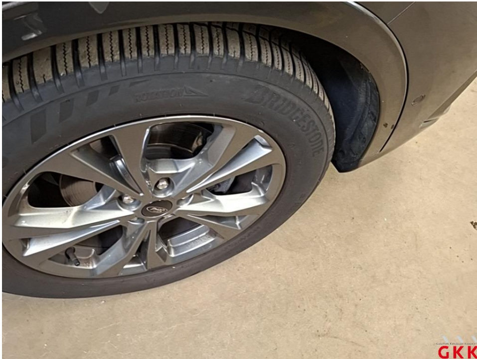
Bild 15 LM-Rad, vorne rechts, Materialabtrag, ersetzen
