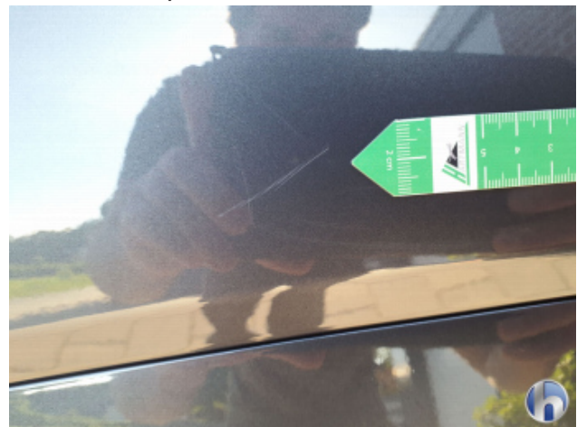
5. Seitenwand - Hinten - Links Kratzer - Smart Repair
