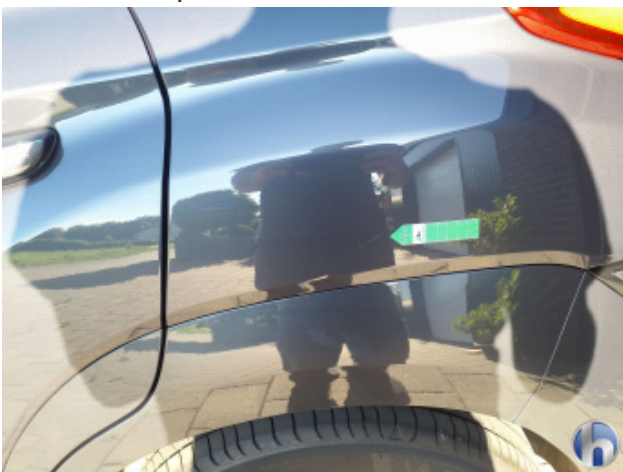
5. Seitenwand - Hinten - Links Kratzer - Smart Repair
