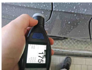
Lackstärke Seitenwand hinten rechts
