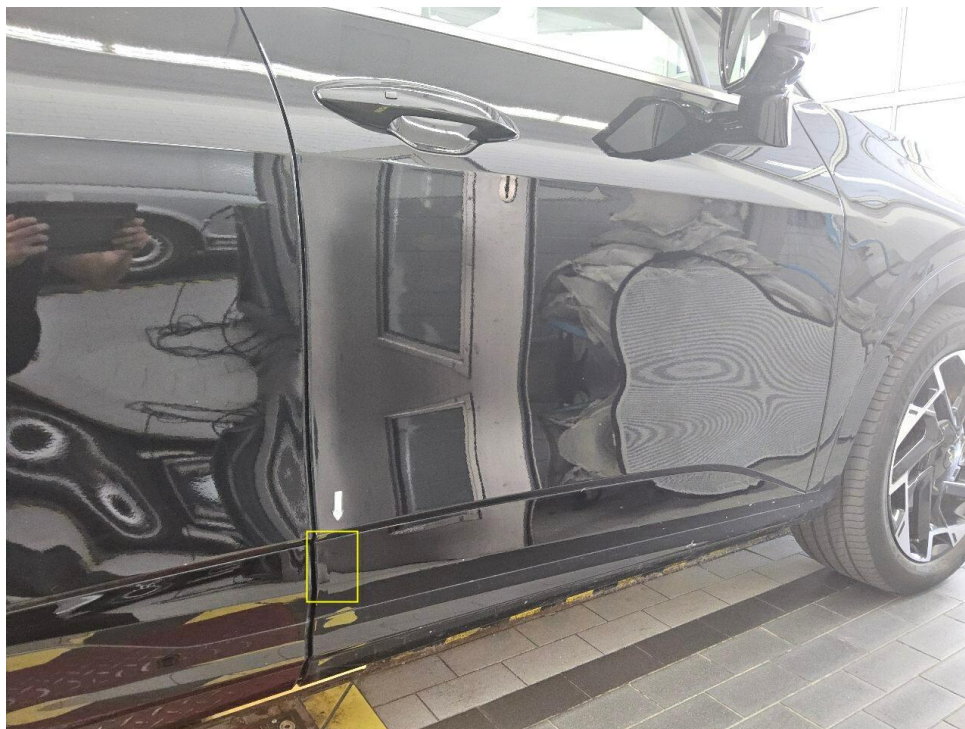
Bild 7 : Tür vorne rechts Schutzleiste unten, eingerissen
