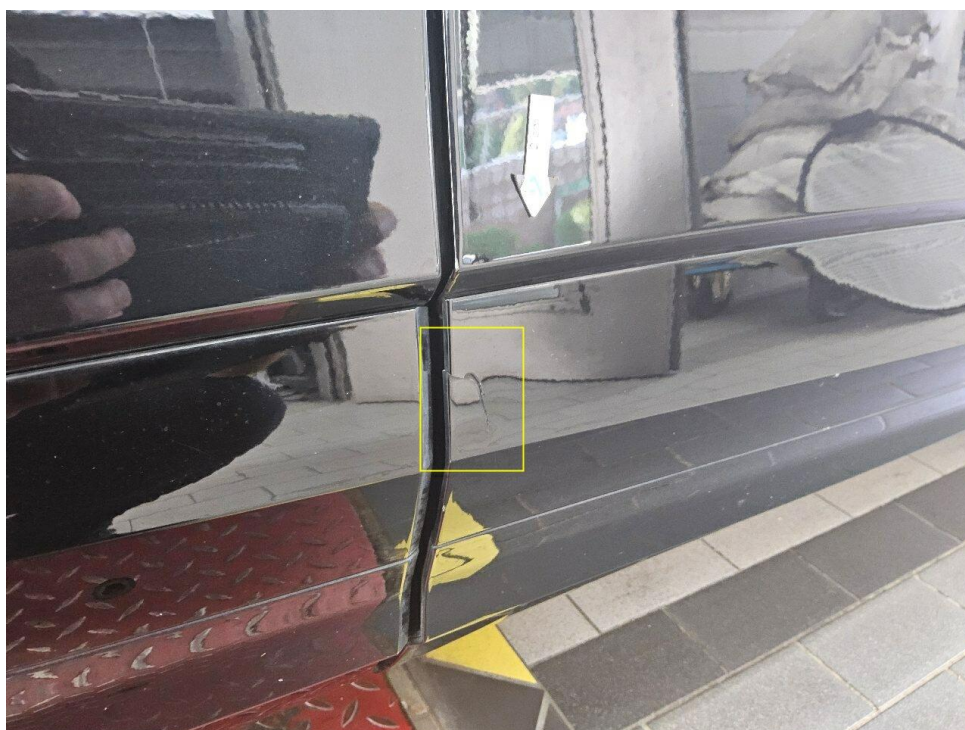
Bild 8 : Tür vorne rechts Schutzleiste unten, eingerissen
