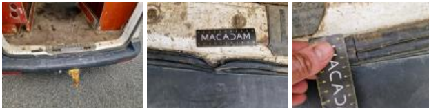
Boot door lining L, Broken, Replace
