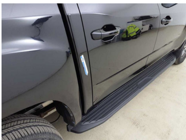
Beschädigung #2: Karosserie: C-Säule rechts - Delle(n) - Smart Repair
