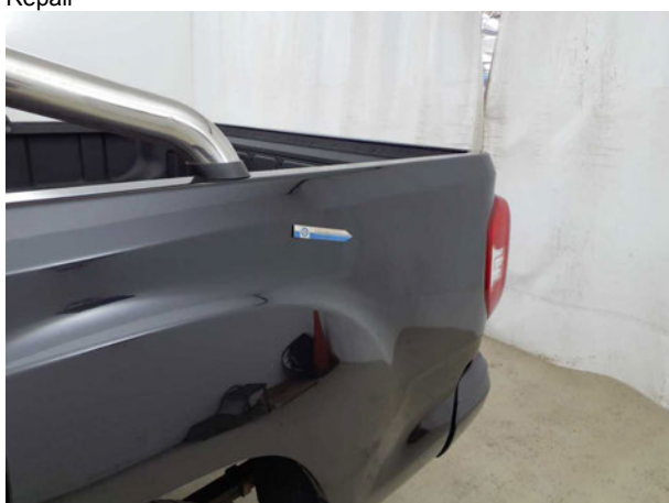
Beschädigung #3: Seitenwand links: Seitenwand - Kratzer - Smart Repair
