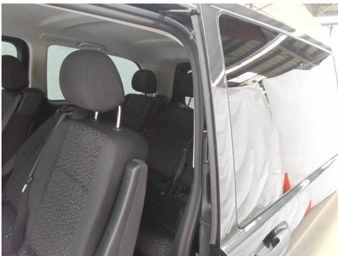
Damage 3: Sliding door - left side: Door seal - Loose - Replace
