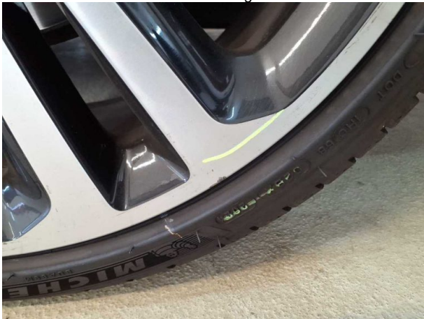
Beschädigung #8: Rad/Reifen: Leichtmetallfelge vorn rechts - verkratzt / verschürft - Wertminderung
