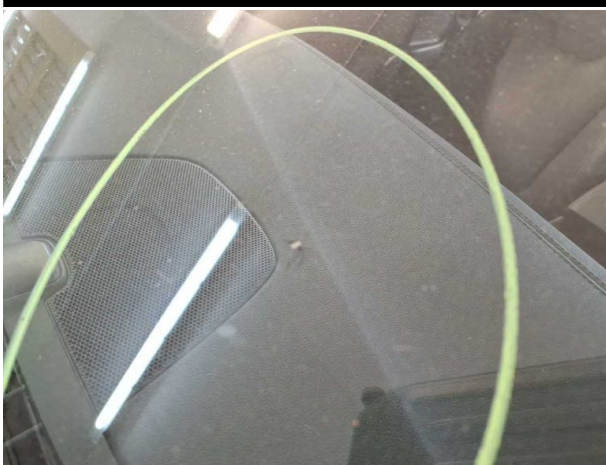
Beschädigung #12: Verglasung: Frontscheibe - Steinschlag - erneuern
