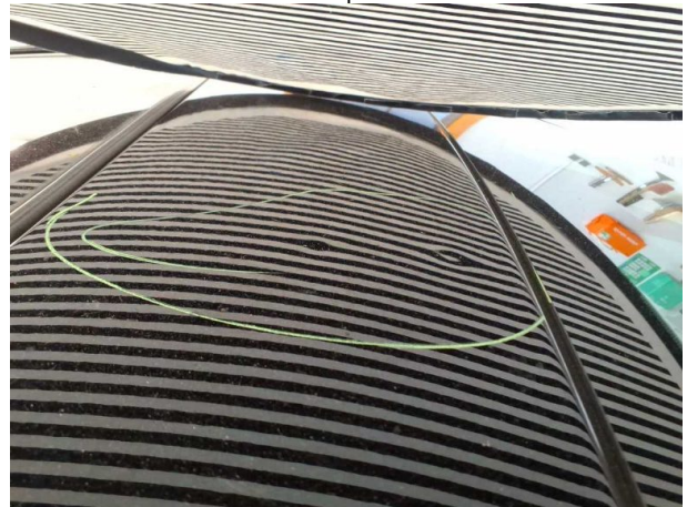
Beschädigung #11: Fahrzeugdach: Dach - Delle(n) - sanft instandsetzen
