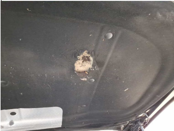
Beschädigung #5: Motorhaube: Dämmmatte - Marderschaden - erneuern
