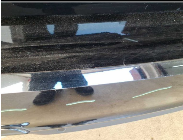
Beschädigung #13: Stossfänger hinten: Stossfänger hinten - verkratzt / verschürft - instandsetzen und lackieren
