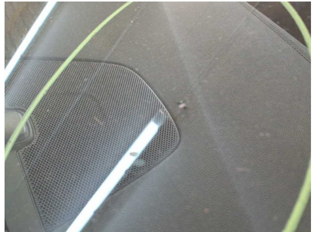
Beschädigung #12: Verglasung: Frontscheibe - Steinschlag - erneuern
