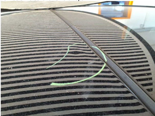
Beschädigung #11: Fahrzeugdach: Dach - Delle(n) - sanft instandsetzen
