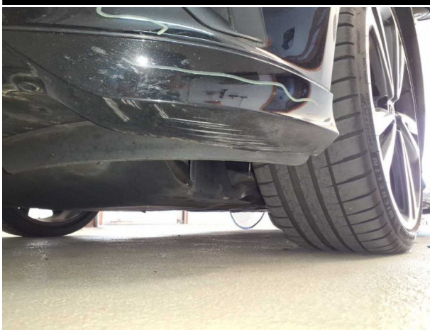
Beschädigung #10: Stossfänger vorn: Stossfänger vorn - verkratzt / verschürft - Smart Repair
