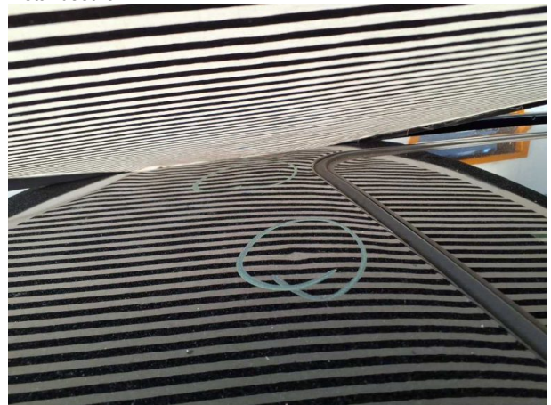
Beschädigung #11: Fahrzeugdach: Dach - Delle(n) - sanft instandsetzen
