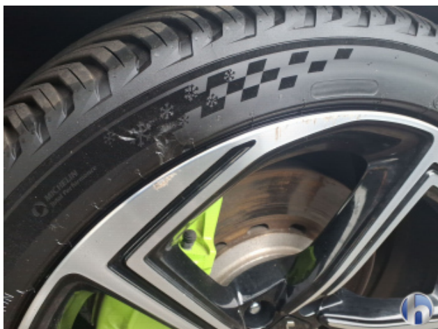
1. Felge Vorne - Links Kratzer - Smart Repair
