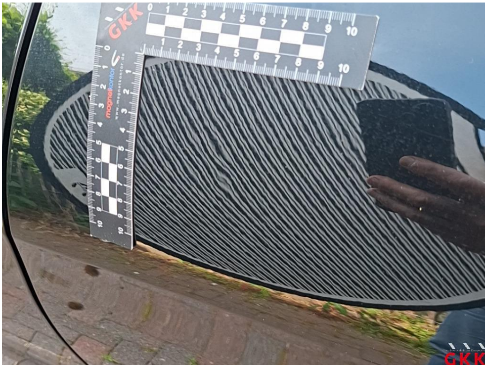
Bild 32. Tür hinten links, bis 3 Dellen / Bauteil, Smartrepair
