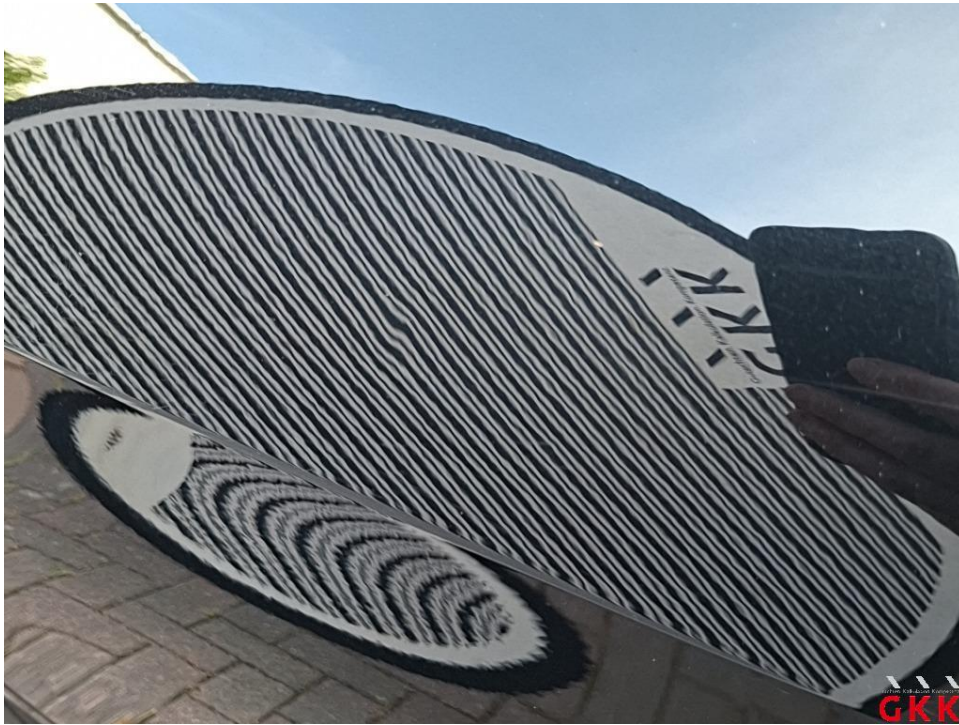
Bild 43. Tür hinten rechts, beschädigt, instand setzen - lackieren
