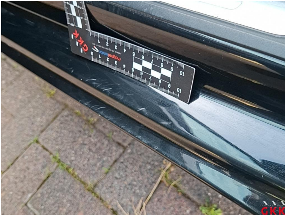
Bild 31. Tür vorne links, Einstieg, verkratzt, lackieren
