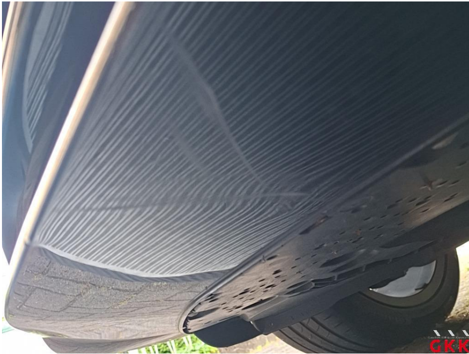
Bild 23. Stoßfänger vorne, Verkleidung -lackiert-, beschädigt, ersetzen
