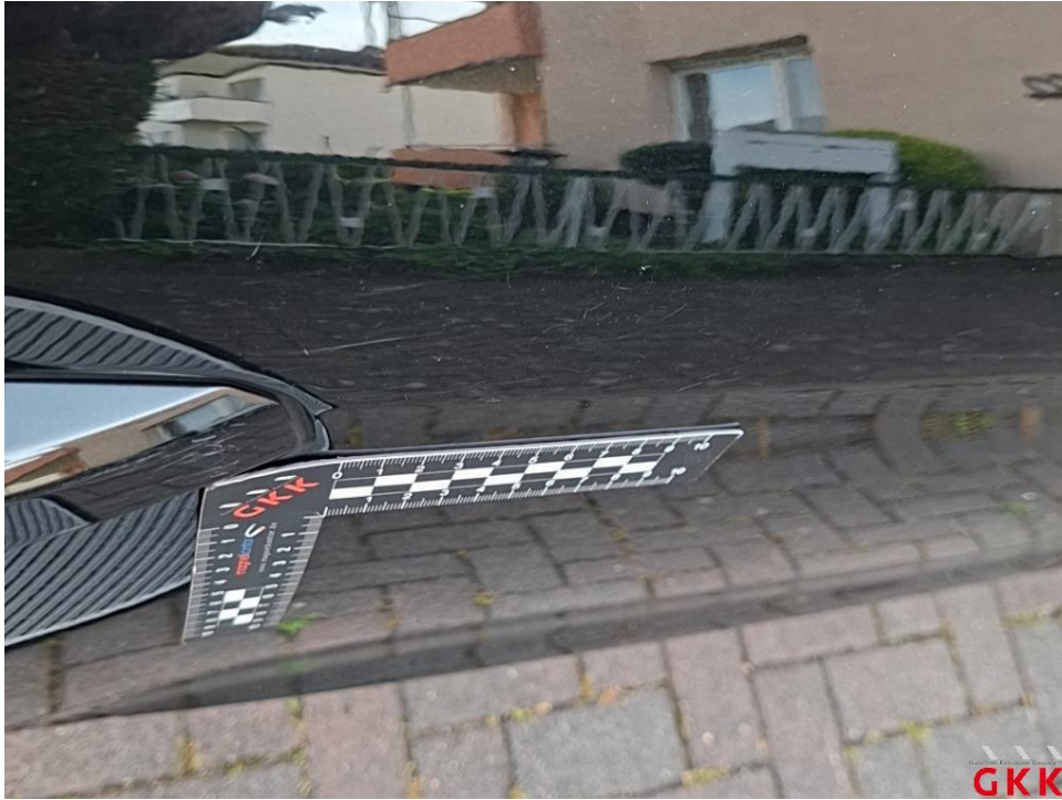
Bild 41. Tür hinten rechts, beschädigt, instand setzen - lackieren
