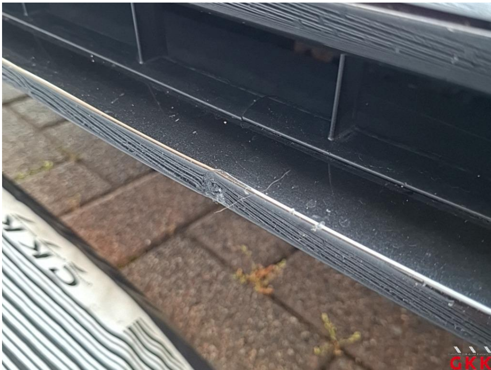
Bild 22. Stoßfänger vorne, Verkleidung -lackiert-, beschädigt, ersetzen
