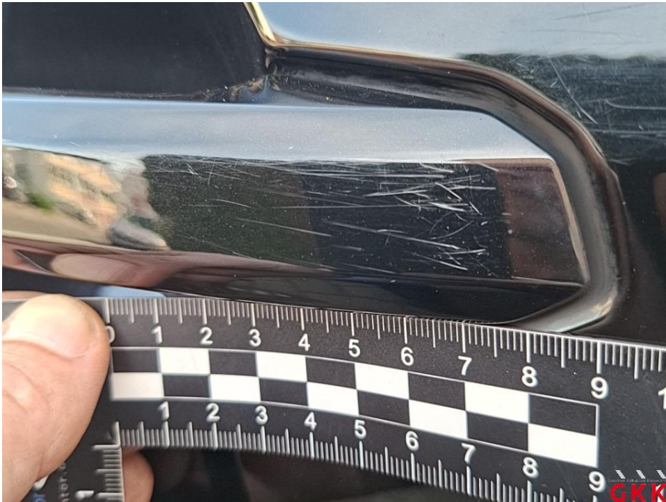
Bild 40. Tür hinten rechts, Griff, verkratzt, lackieren
