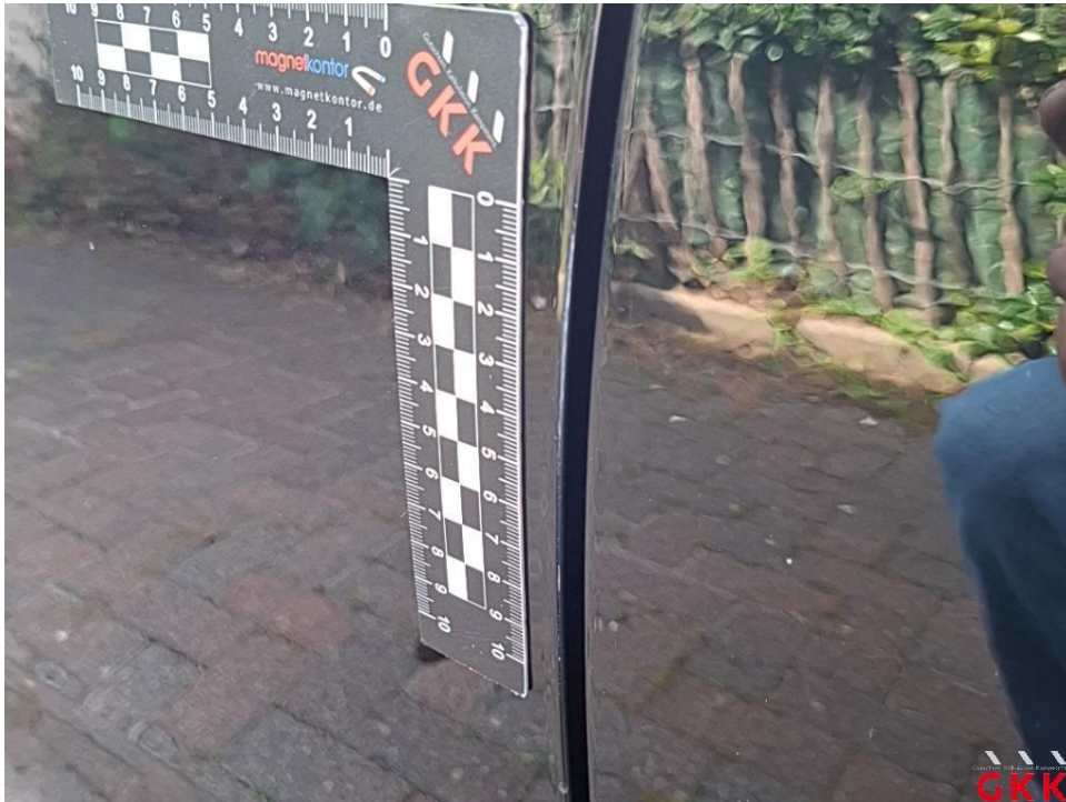
Bild 30. Tür vorne links, Kante, verkratzt, Smartrepair
