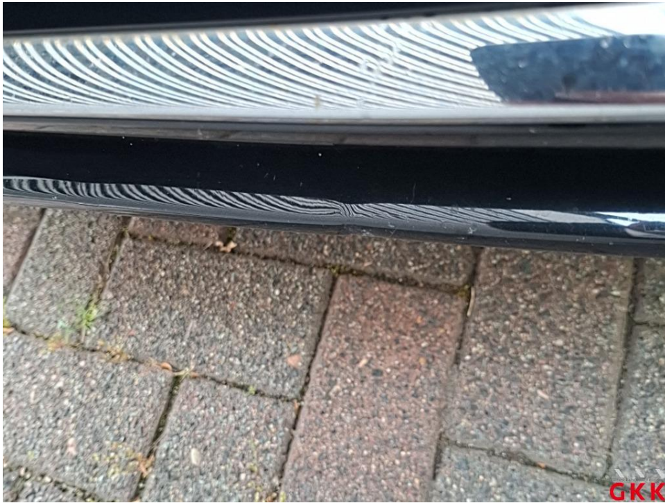
Bild 21. Stoßfänger vorne, Verkleidung -lackiert-, beschädigt, ersetzen
