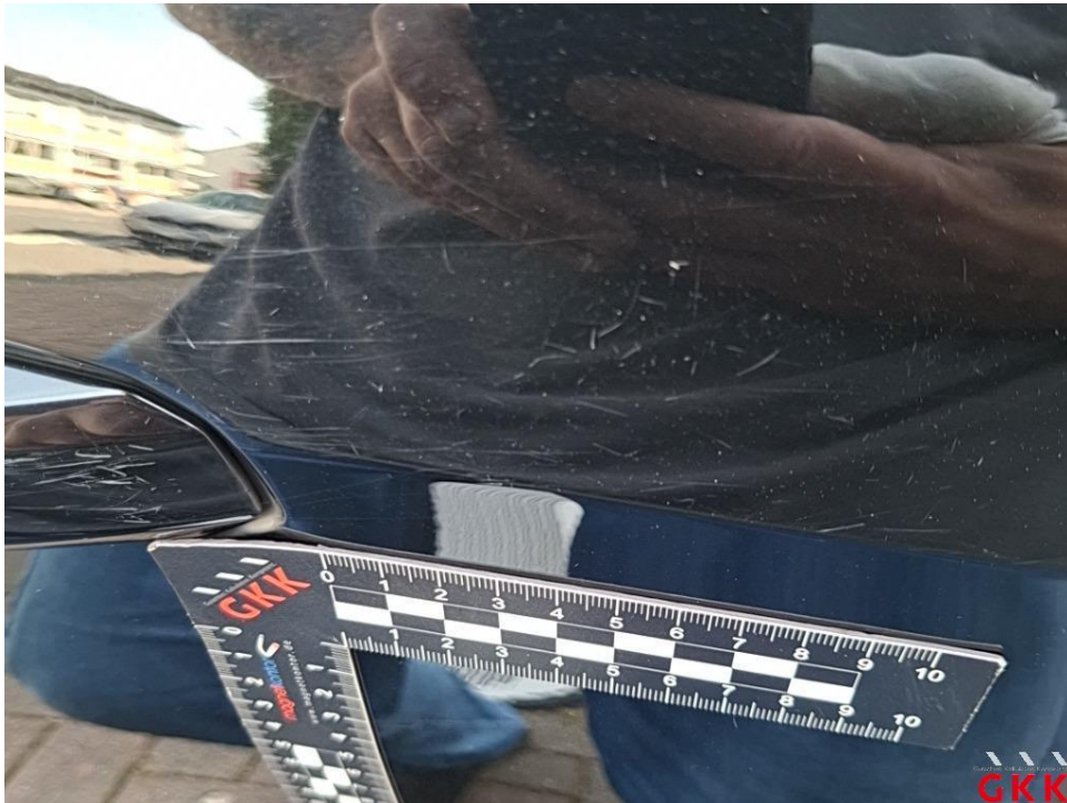
Bild 42. Tür hinten rechts, beschädigt, instand setzen - lackieren
