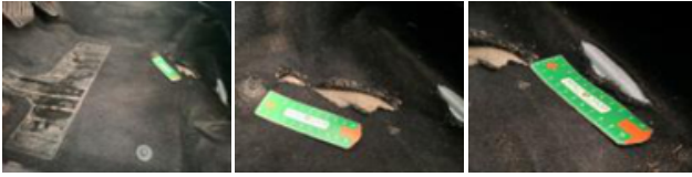
Tapis de sol AV, Déchirure, E - Remplacer
