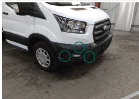
Stoßfänger unterhalb / Vorne / Kratzer
