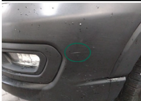
Stoßfänger unterhalb / Vorne / Kratzer
