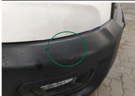
Stoßfänger unterhalb / Vorne / Kratzer
