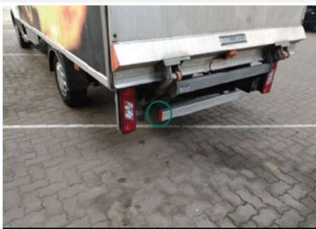
Stoßfänger / Hinten / Delle
