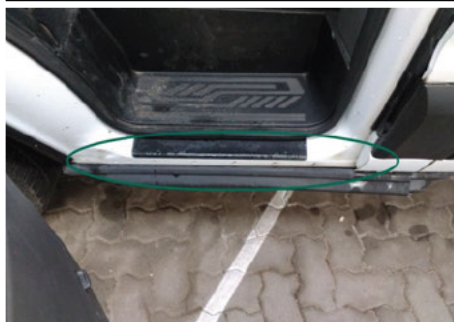
Dichtung Türeinstieg / Vorne Links / Fehlt
