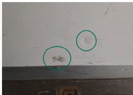
Seitenwand / Rechts / Gebrochen
