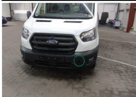
Abdeckung Abschleppöse / Vorne / Fehlt
