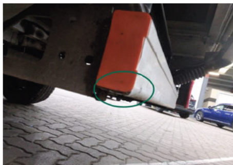
Stoßfänger / Hinten / Delle
