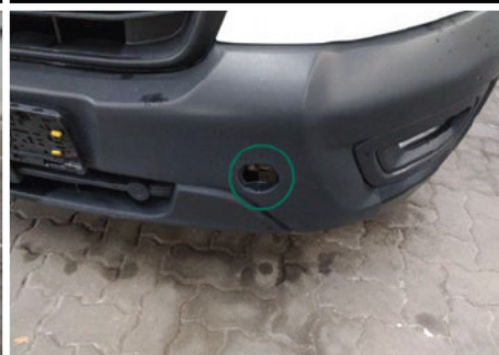
Abdeckung Abschleppöse / Vorne / Fehlt
