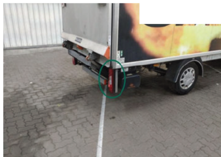
Rücklicht Halterung / Hinten Rechts / Nicht konform
