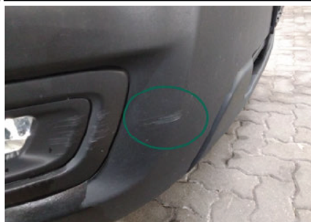
Stoßfänger unterhalb / Vorne / Kratzer
