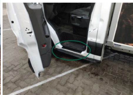
Dichtung Türeinstieg / Vorne Links / Fehlt
