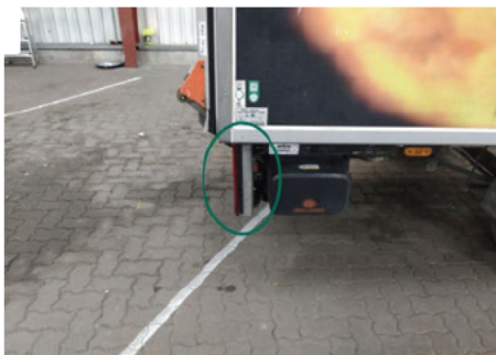
Rücklicht Halterung / Hinten Rechts / Nicht konform
