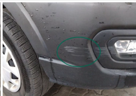
Stoßfänger unterhalb / Vorne / Kratzer
