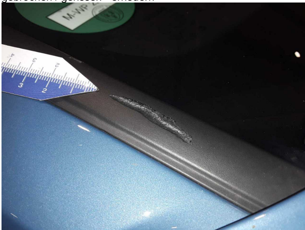
Beschädigung #1: Verglasung: Frontscheibendichtung - gebrochen / gerissen - erneuern
