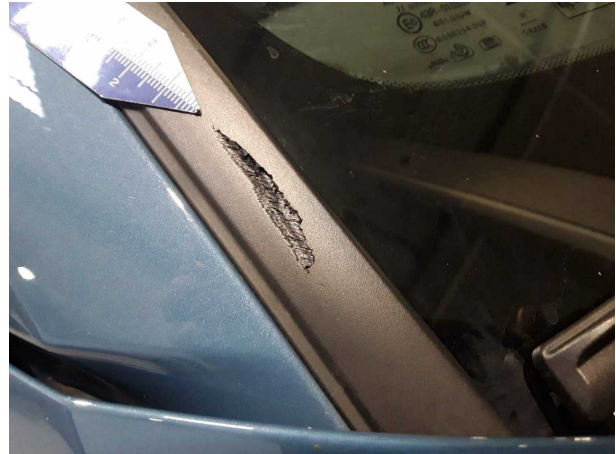
Beschädigung #1: Verglasung: Frontscheibendichtung - gebrochen / gerissen - erneuern
