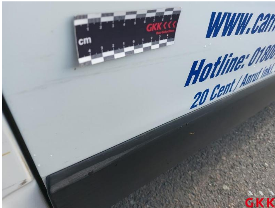
Bild 25. Schiebetür rechts, verkratzt, lackieren
