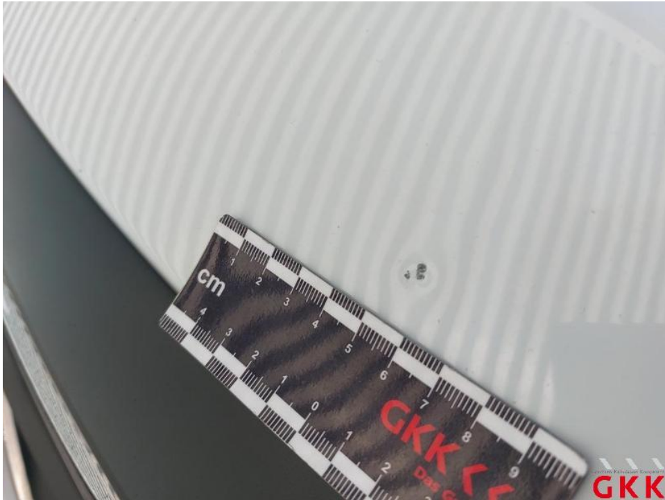
Bild 17. Motorhaube, beschädigt, instand setzen - lackieren
