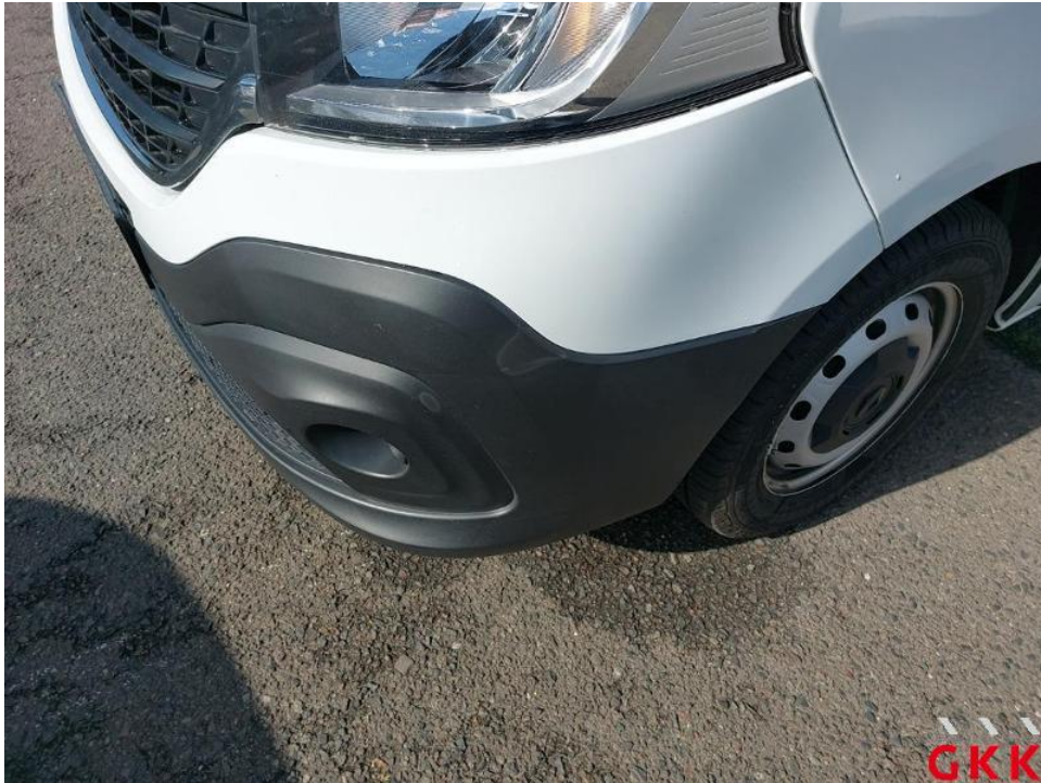
Bild 13. Stoßfänger vorne, Verkleidung -teillackiert-, beschädigt, ersetzen
