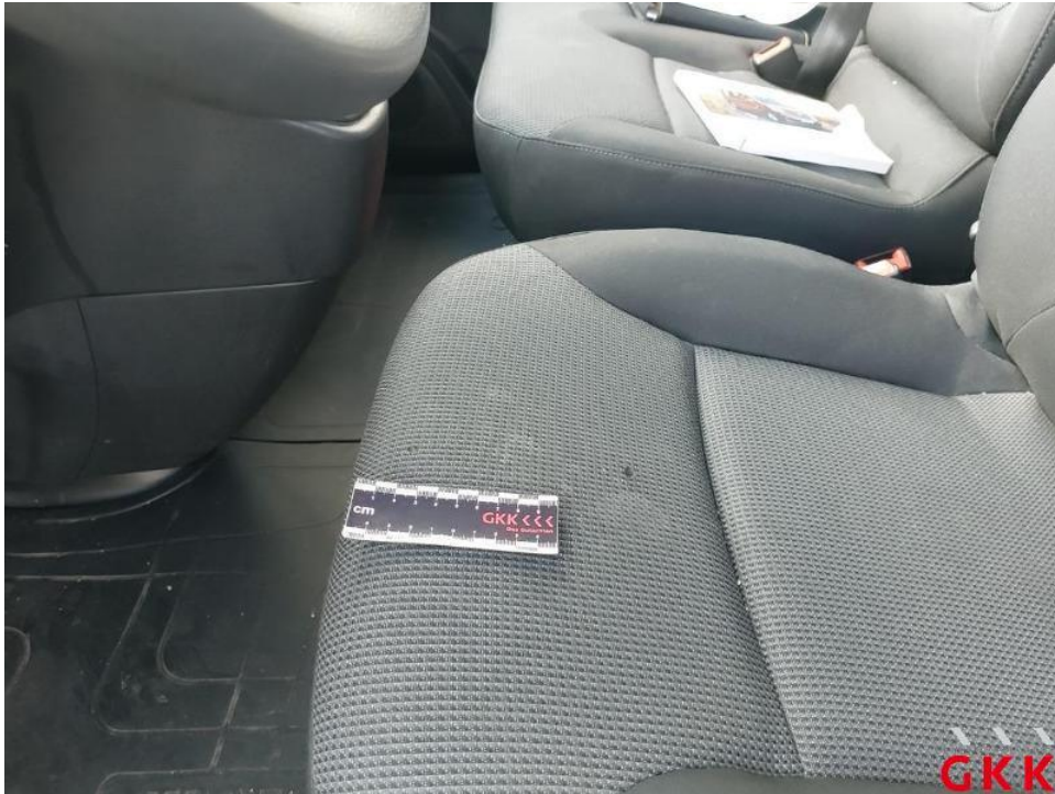
Bild 43. Sitz vorne links, Bezug Sitzkissen -Stoff-, beschädigt, ersetzen
