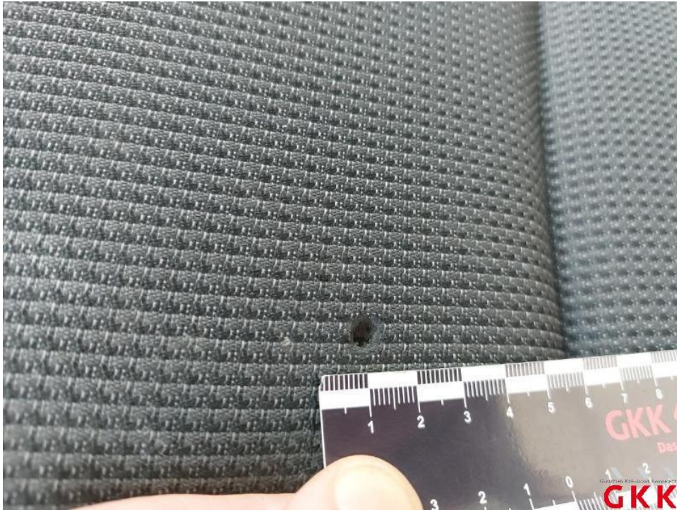
Bild 45. Sitz vorne links, Bezug Sitzkissen -Stoff-, beschädigt, ersetzen
