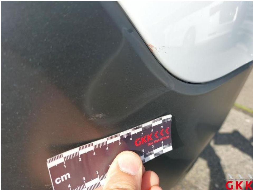
Bild 14. Stoßfänger vorne, Verkleidung -teillackiert-, beschädigt, ersetzen
