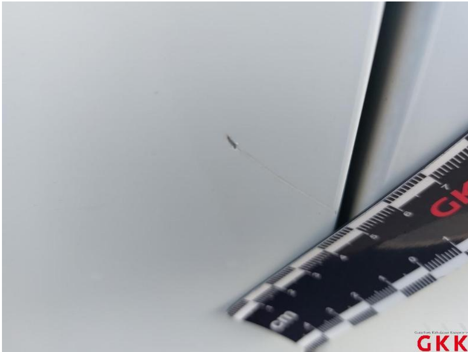
Bild 24. Tür vorne rechts, verkratzt, Smartrepair
