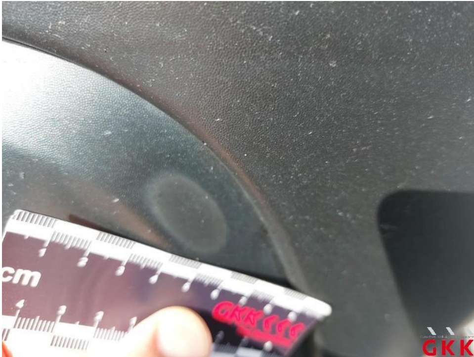
Bild 15. Stoßfänger vorne, Verkleidung -teillackiert-, beschädigt, ersetzen
