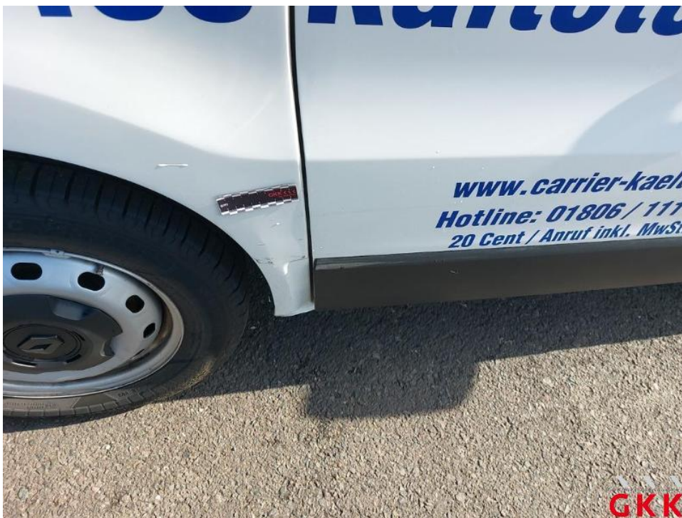
Bild 28. Seitenwand rechts, beschädigt, instand setzen - lackieren
