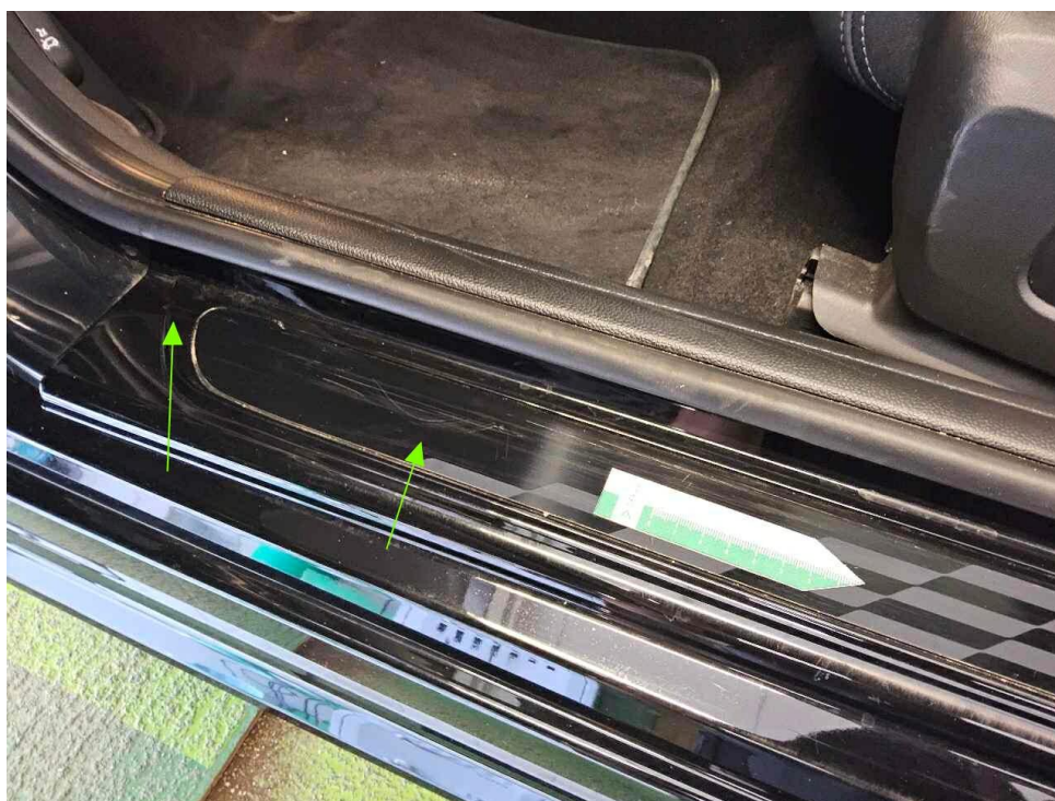
Bild 16 : Leiste Einstieg rechts zerkratzt Seitenschweller links Schwellerblende, verschrammt, smart repair
