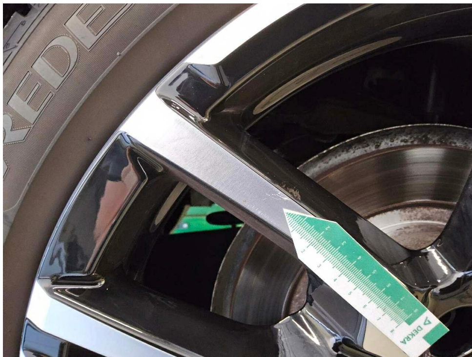
Bild 18 : Felge hinten links verschrammt
