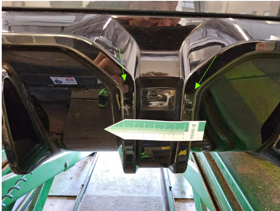
Bild 21 : Spoiler Stoßfänger hinten mehrfach angestoßen
