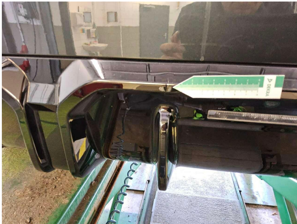
Bild 22 : Spoiler Stoßfänger hinten mehrfach angestoßen
