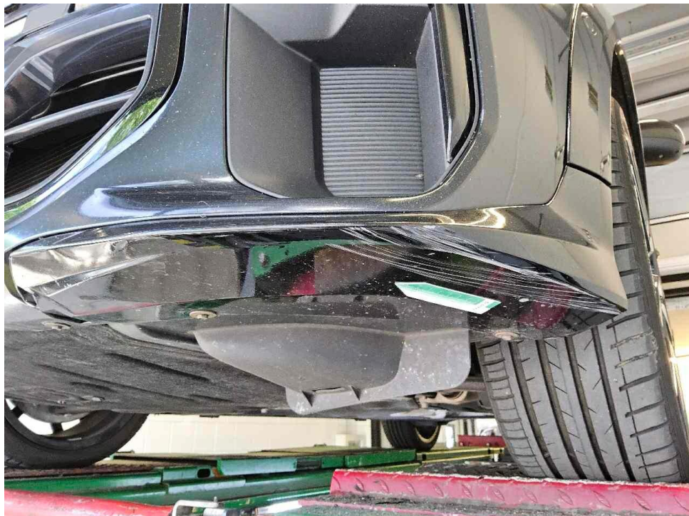
Bild 26 : Spoiler vorn links verschrammt
