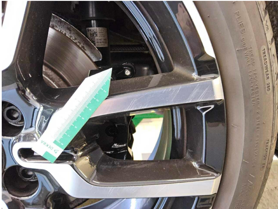
Bild 17 : Felge hinten links verschrammt
