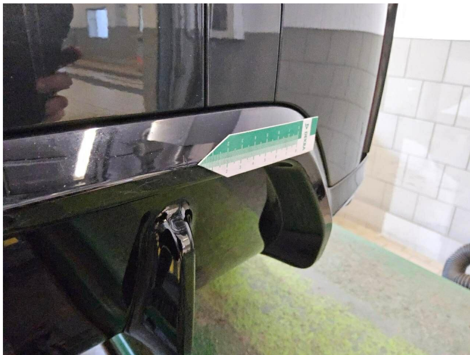
Bild 20 : Spoiler Stoßfänger hinten mehrfach angestoßen
