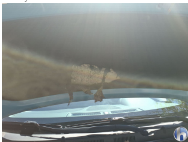
1. Motordämmmaterial Marderbiss /-schaden - Erneuern
