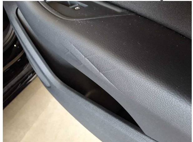
Beschädigung #2: Verkleidungen/Abdeckungen: Türverkleidung hinten rechts - verformt - Wertminderung
