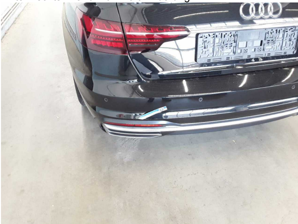
Beschädigung #3: Stossfänger hinten: Stossfänger hinten - verkratzt / verschürft - Smart Repair
