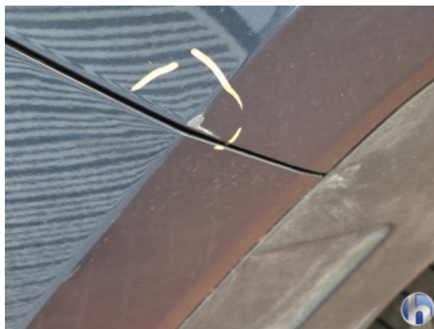
1. Seitenwand - Hinten - Rechts Lackabplatzer - Smart Repair
