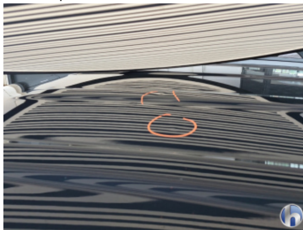
2. Dach Gebrauchsspuren - Nacharbeiten
