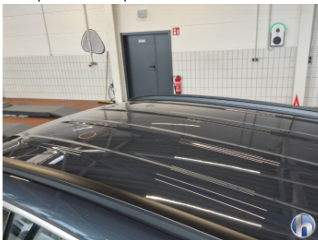
2. Dach Gebrauchsspuren - Nacharbeiten
