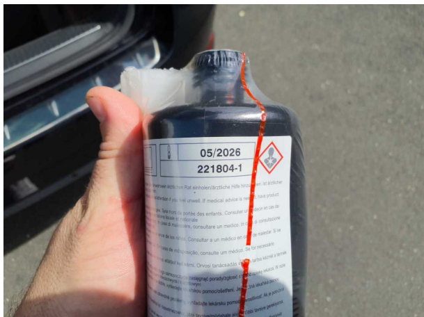
Beschädigung #1: Ausrüstung: Tirefit Füllmittel - abgelaufen - erneuern
