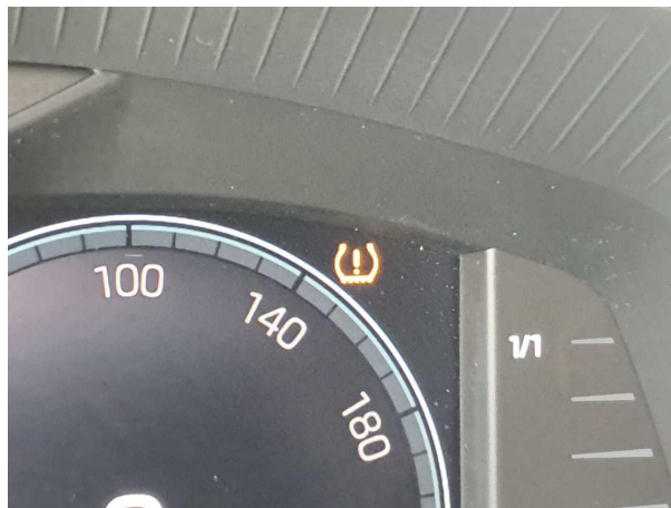
Beschädigung #2: elektronische Systeme: elektronische Systeme (RDKS) - leuchtet - befunden ggf. instandsetzen
