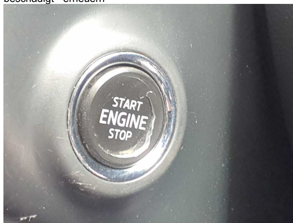
Beschädigung #4: Interieur: Innenraum (Startknopf) - gebrochen / gerissen - erneuern
