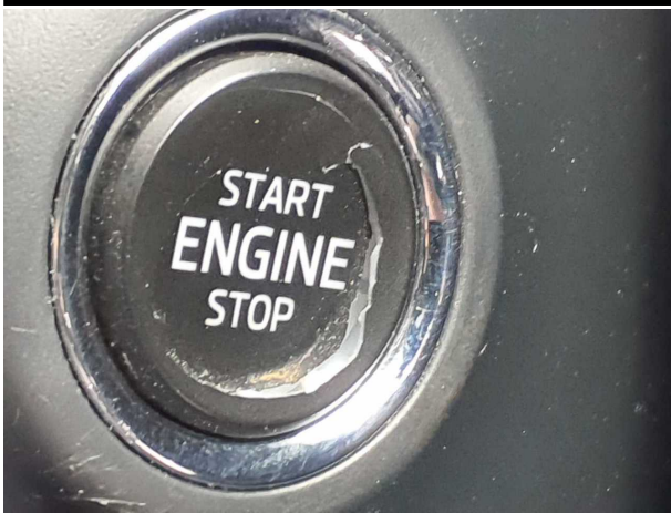
Beschädigung #4: Interieur: Innenraum (Startknopf) - gebrochen / gerissen - erneuern
