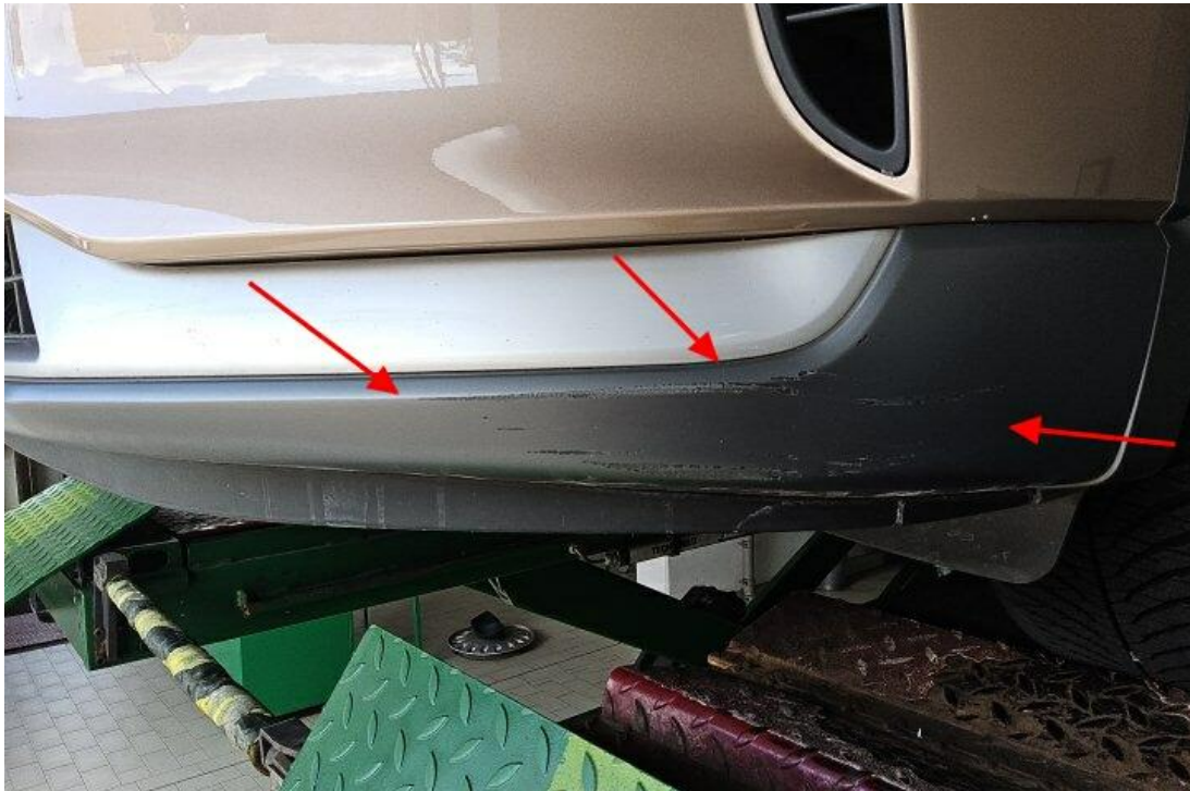
Bild 9 : Stoßfänger vorne Lackierung, verschrammt, lackieren mit Lackaufbau
