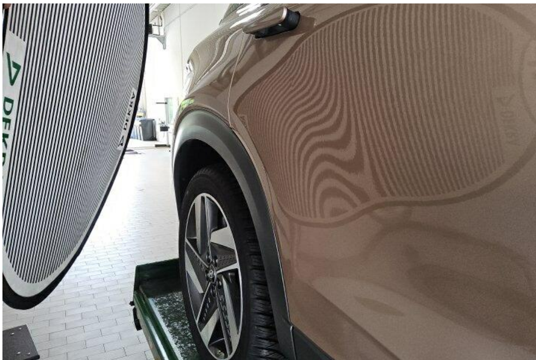
Bild 12 : Tür hinten rechts, eingedellt, Gebrauchsspur
