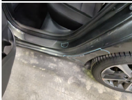
Türeinstieg / Hinten Links / Delle
