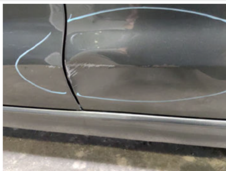
Tür / Hinten Links / Delle
