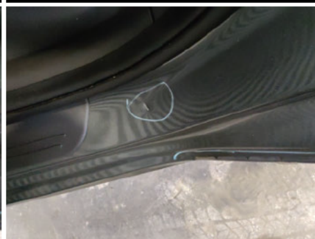
Türeinstieg / Hinten Links / Delle
