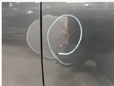
Tür / Hinten Links / Delle
