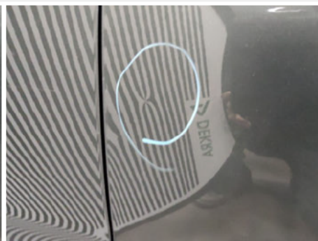
Tür / Hinten Links / Delle
