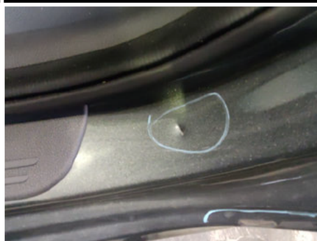
Türeinstieg / Hinten Links / Delle
