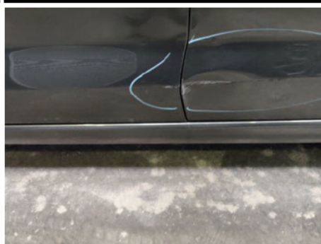
Tür / Vorne Links / Delle
