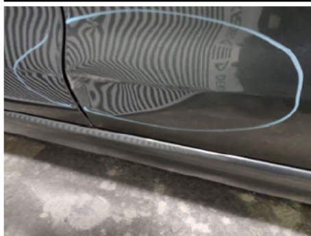
Tür / Hinten Links / Delle
