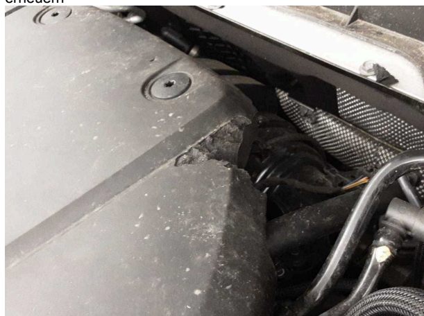
Beschädigung #4: Motor: Motorabdeckung - Marderschaden - erneuern
