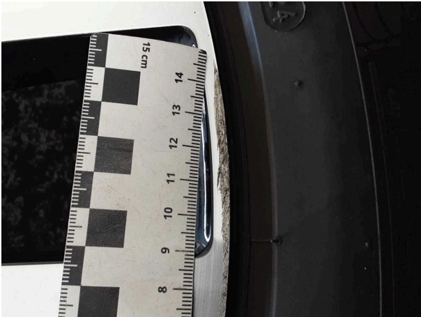
Beschädigung #6: 2.Radsatz: 1 Leichtmetallfelge - verkratzt / verschürft - erneuern
