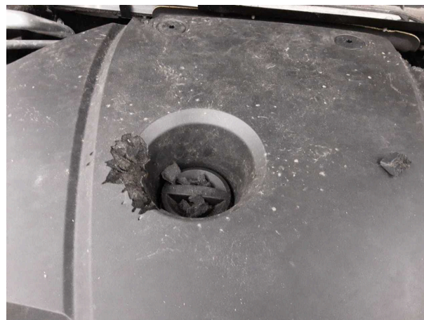
Beschädigung #4: Motor: Motorabdeckung - Marderschaden - erneuern
