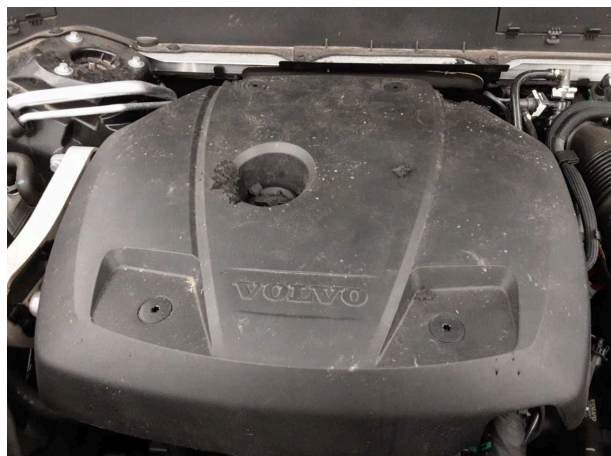
Beschädigung #4: Motor: Motorabdeckung - Marderschaden - erneuern
