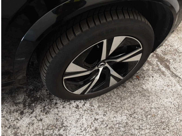
Beschädigung #1: Rad/Reifen: Reifen vorn rechts (Winter) - porös / rissig - kein Abzug
