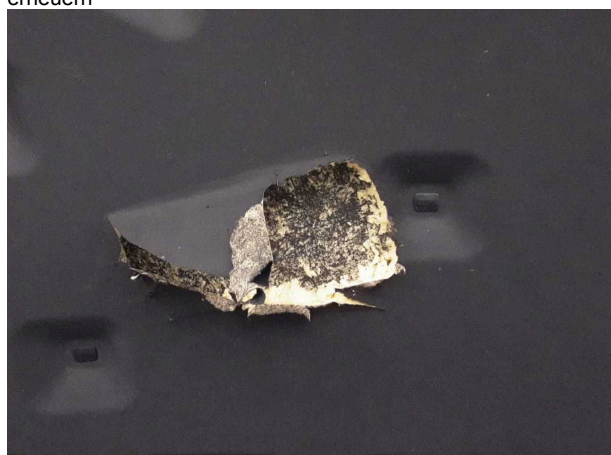
Beschädigung #5: Motorhaube: Dämmmatte - Marderschaden - erneuern
