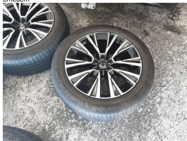
Beschädigung #6: 2.Radsatz: 1 Leichtmetallfelge - verkratzt / verschürft - erneuern
