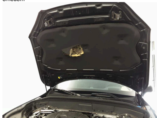
Beschädigung #5: Motorhaube: Dämmmatte - Marderschaden - erneuern
