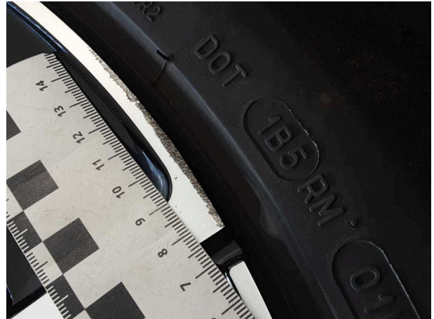
Beschädigung #6: 2.Radsatz: 1 Leichtmetallfelge - verkratzt / verschürft - erneuern
