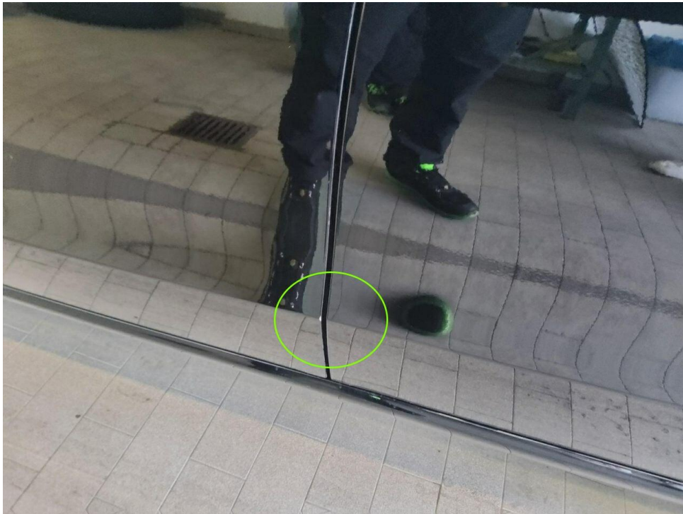
Bild 19 : Tür vorne links Türkante, zerkratzt, Gebrauchsspur
