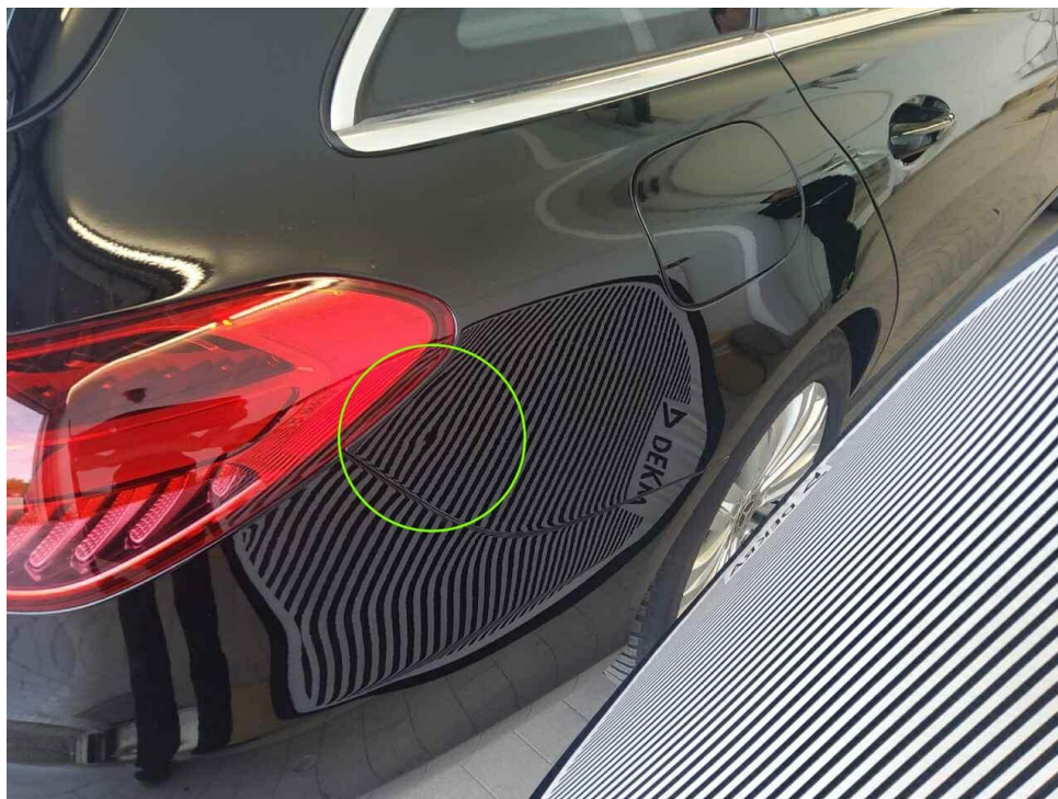
Bild 15 : Seitenteil hinten rechts, eingedellt, drücken
